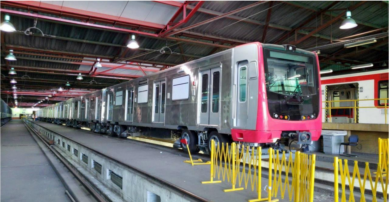
Imagen 1: Fotografía de tren NS16 en foso mantenimiento Taller Neptuno (L1) [16].
