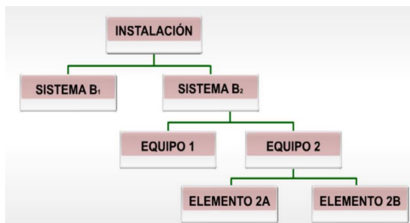
Gráfico 11: ejemplo de jerarquización de una instalación [24].
