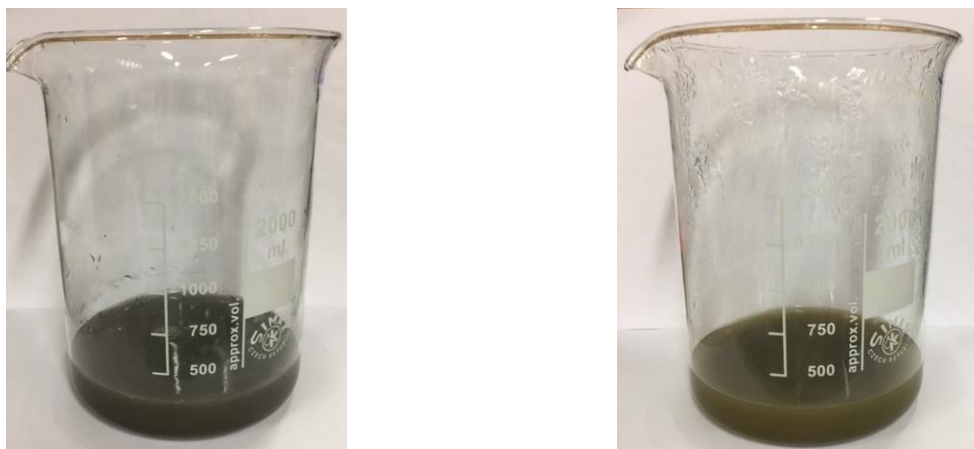
Figura 8.4: Antes y después de la muestra AEL-33 de ser sometida al NAG.
