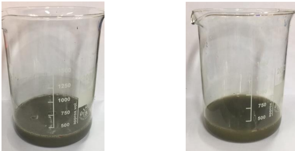
Figura 8.8: Antes y después de la muestra Cola 25 de ser sometida al NAG.
