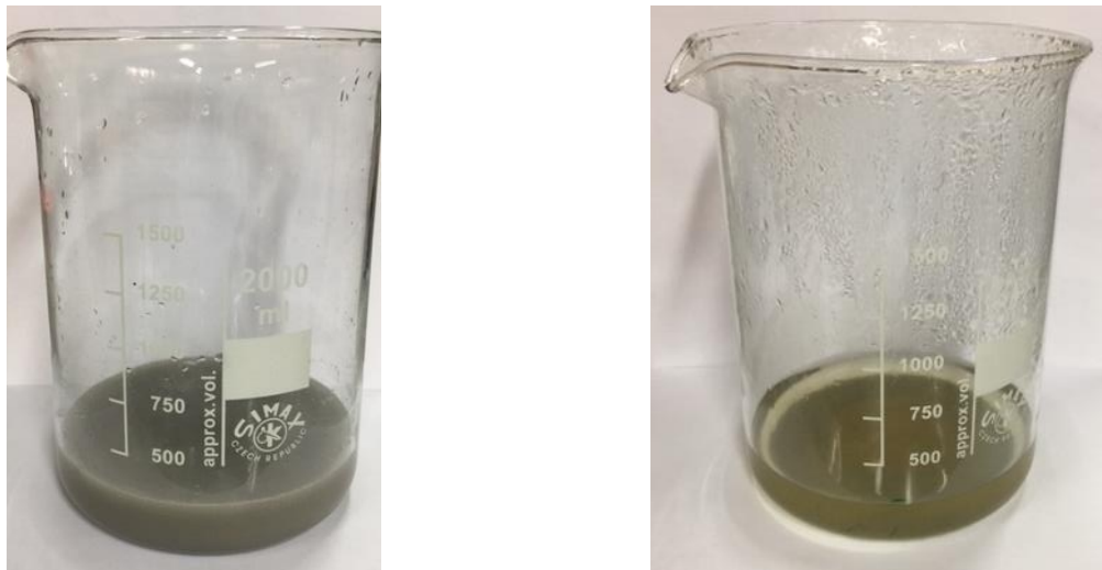
Figura 8.5: Antes y después de la muestra CM de ser sometida al NAG.
