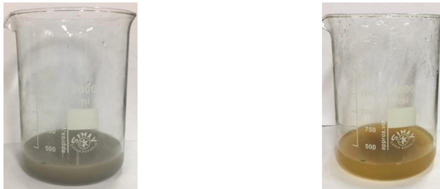
Figura 8.11: Antes y después de la muestra CM de ser sometida al NAG (~1 gr).
