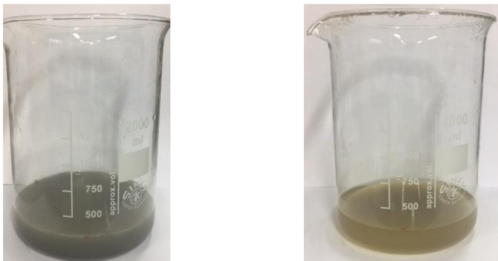
Figura 8.12: Antes y después de la muestra Cola 25 de ser sometida al NAG (~1 gr).
