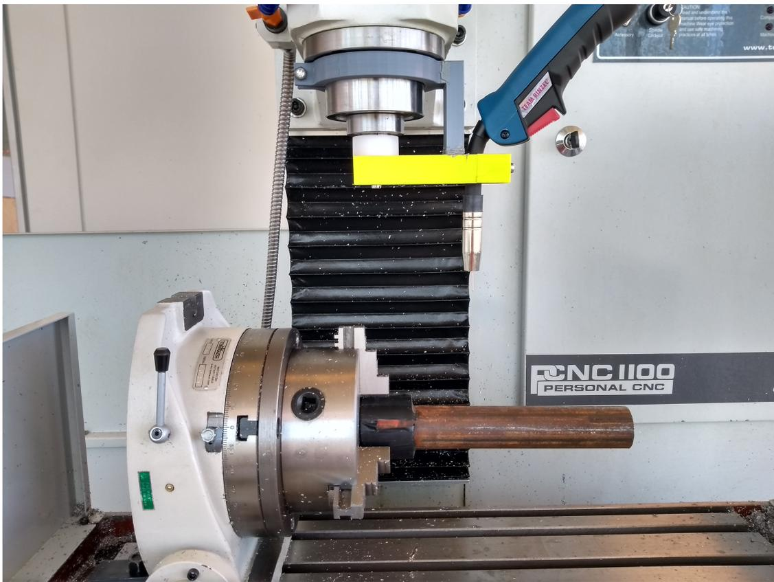
Figura 3.4: Agarres de antorcha y barra montados en el equipo CNC
