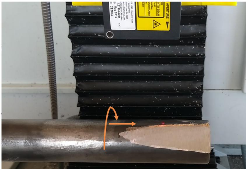
Figura 5.1: Movimientos de escáner láser para toma de datos
