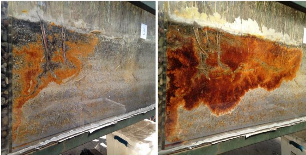
Figura 3-3. Zonación de hidróxidos de Fe. Izquierda: 46 días de operación. Derecha: 150 días de operación. Fotos: Ignacio Jaque.
