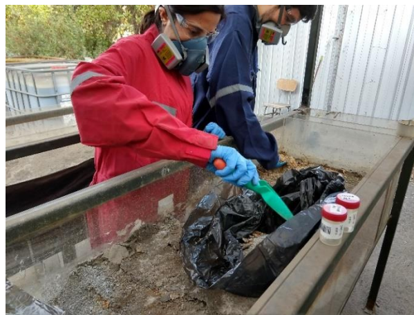
Figura 3-6. Proceso de muestreo de sustratos. Humedal de caliza sin vegetación.
