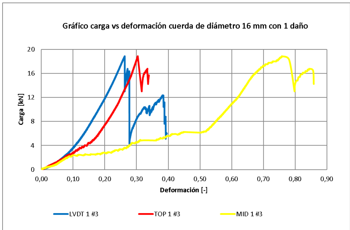
Figura 65: Gráfico completo carga vs deformación cuerda de diámetro 16 mm con 1 daño ensayo numero 3
