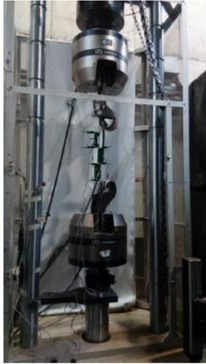
Figura 10: Montaje experimental de la cuerda de diámetro 8 mm con 3 extensómetros
