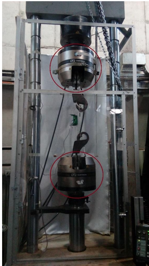
Figura 4: Máquina INSTRON 600 LX largo extendido manual funcionamiento a tracción (círculos rojos mordazas para funcionamiento a tracción)
