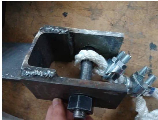
Figura 13: Unión placa metálica y ojal de cuerda de poliéster
