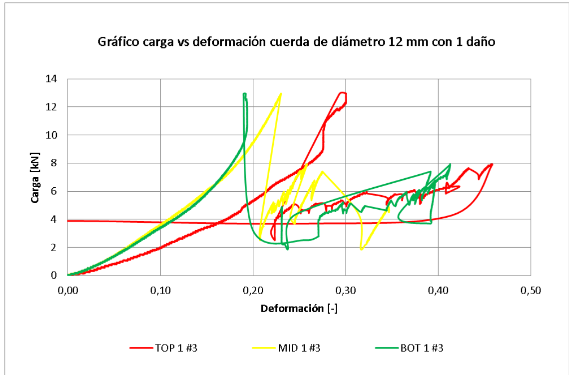
Figura 51: Gráfico completo carga vs deformación cuerda de diámetro 12 mm con 1 daño ensayo numero 3
