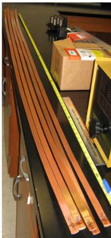
(a) Tubos de minicanales de cobre después de la extrusión.
