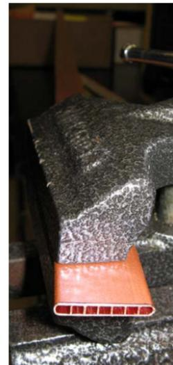
(b) Vista transversal del tubo de minicanales.
