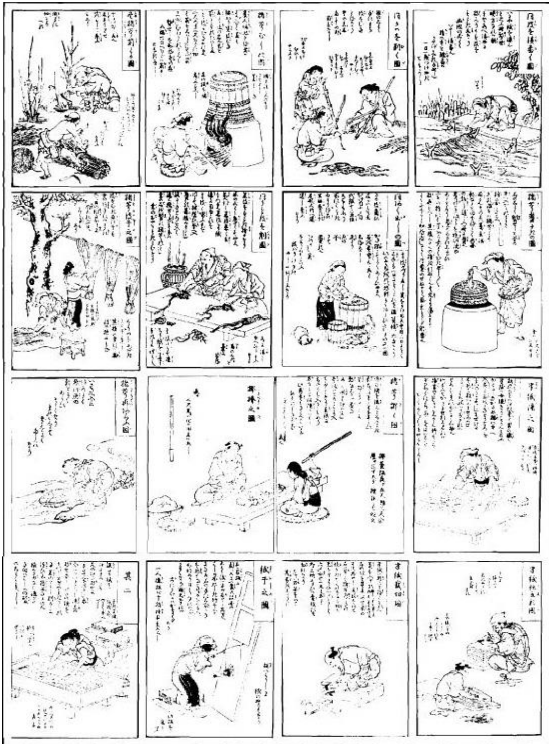
(Figura 6) Estampas del Knmi suki cho ho ki. Manual de la fabricación del papel . 1798, época Edo. En dichas estampas se representa el método tradicional de fabricación del papel en Japón.
