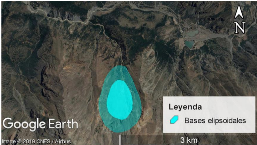
Figura 54: Representación de la geometría estimada en la zona de arranque de Pangal III, correspondiente a un cono truncado invertido de base elipsoidal.
