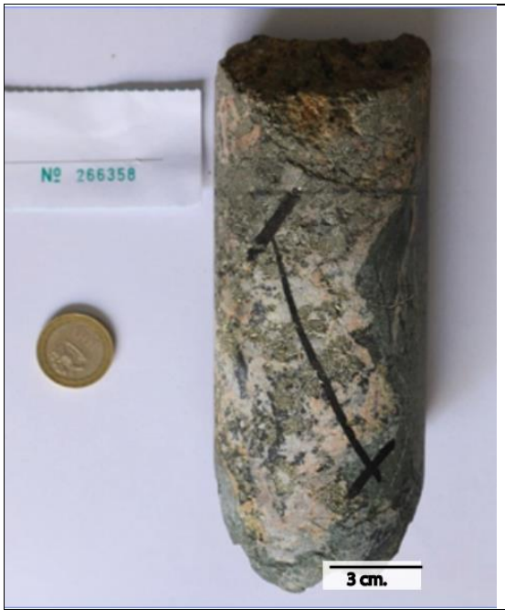
Figura 13 Muestra 266358: Veta de feldspato k. con pirita y magnetita
