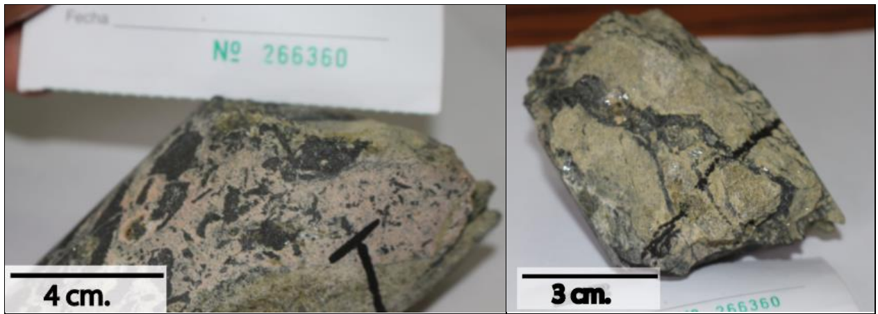
Figura 16 Muestra 266360: Se observa la textura de agregado cristalino de grano fino compuesto por epidota, feldespato, pirita, magnetita. Vetillas de magnetita cortan la textura descrita.
