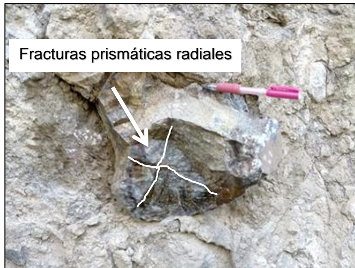
Figura 24. Bloques con diaclasas prismáticas o PJB. Líneas blancas demarcan las trazas de las fracturas concéntricas
