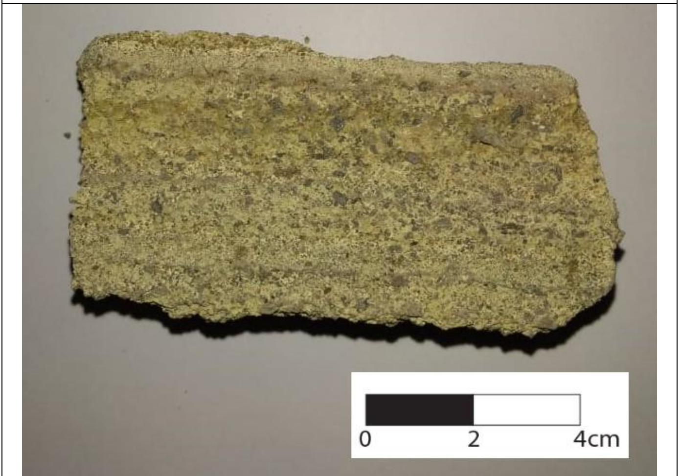
Figura E.13: Toba vítrea perteneciente a los depósitos del centro eruptivo Lliza.
