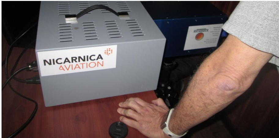
Figura 5. 9. Ensamblaje cuerpo negro-cámara IR. El cuerpo negro es la caja gris, con logo NICARNICA AVIATION. A la derecha se observa la cámara Nicair dirigida hacia la apertura del cuerpo negro.
