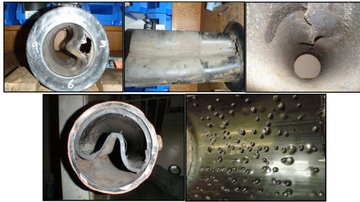
Figura 10: Ejemplos de falla de revestimiento.
