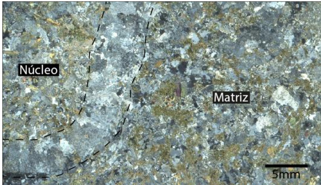
Figura 4.20: La envoltura está formada casi exclusivamente por minerales félsicos, siendo la plagioclasa la fase principal. Las líneas segmentadas marcan los límites de la envoltura. Foto a XPL. Corte E-101.
