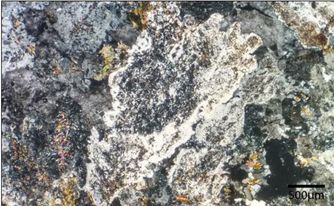
Figura 4.22: Plagioclasa dendrítica fuertemente alterada a saussurita. Este cristal cubre todo el espesor de la envoltura. Foto a XPL. Corte E-102.
