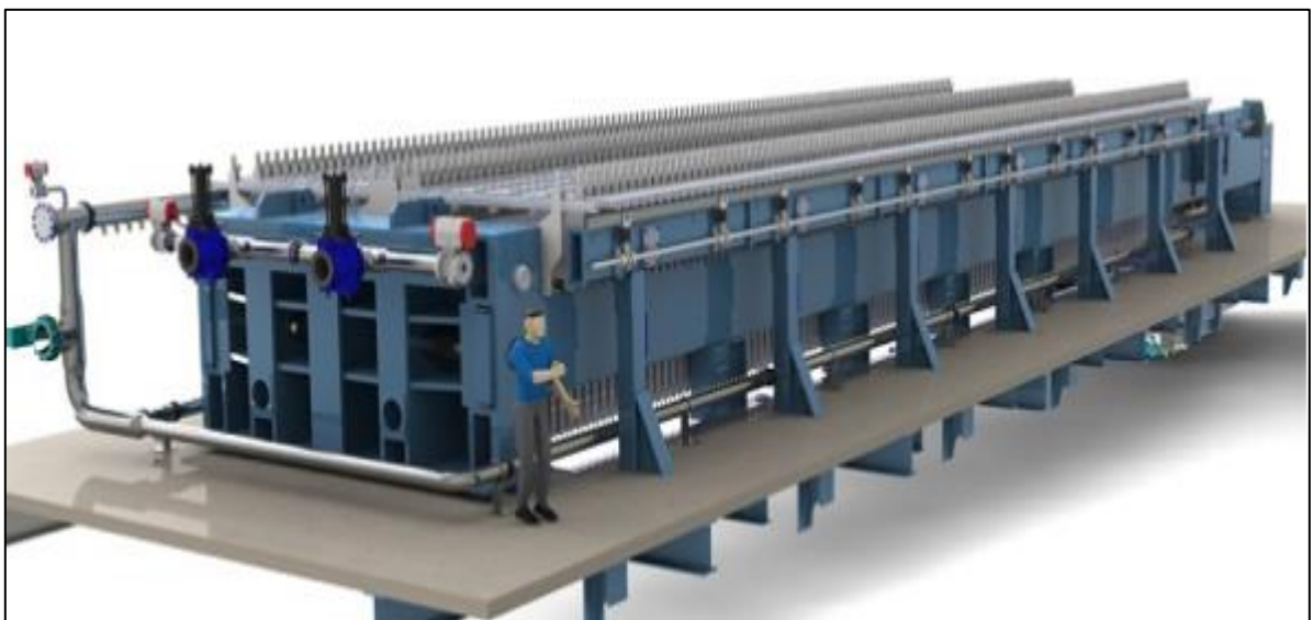
Figura 2.16. Equipo de filtración de relaves (Minería Chilena, 2016).
