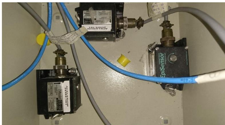
Figura 3.25 Acelerómetros instalados en el subterráneo -2, uno en cada dirección de interés (NS, EO y vertical).
