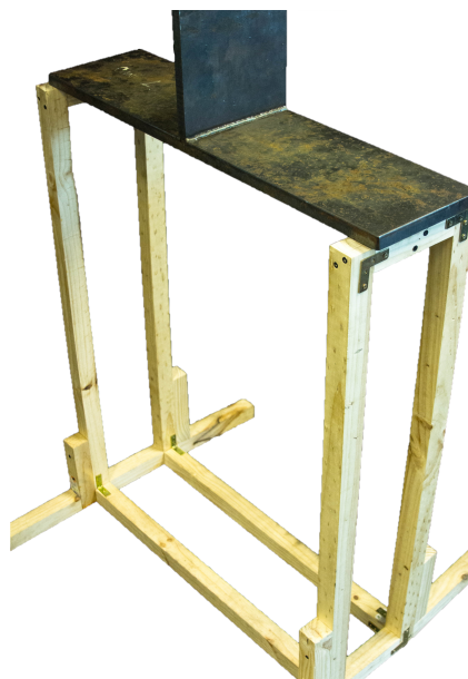
Figura 4.9: Montaje experimental final fabricado. Cuenta con soportes en sus cuatro patas para asegurar su estabilidad.
