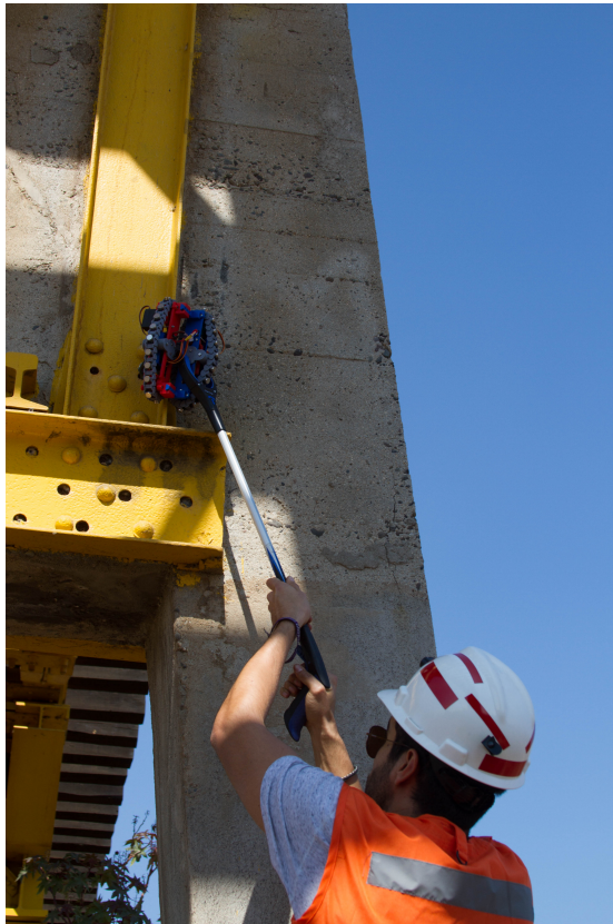
Figura 6.20: Metodología de despliegue y retiro del robot para estructuras difíciles de alcanzar.
