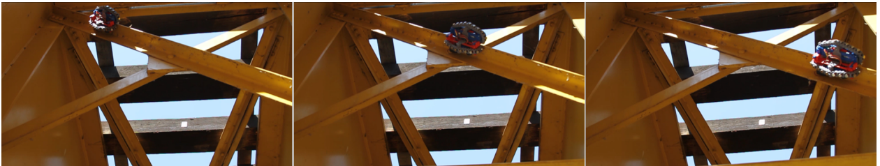
Figura 6.17: Transición de movimiento del robot sobre superficie inclinada de un enrejado interior del puente. Las barras metálicas tienen un grosor de 10[mm].
