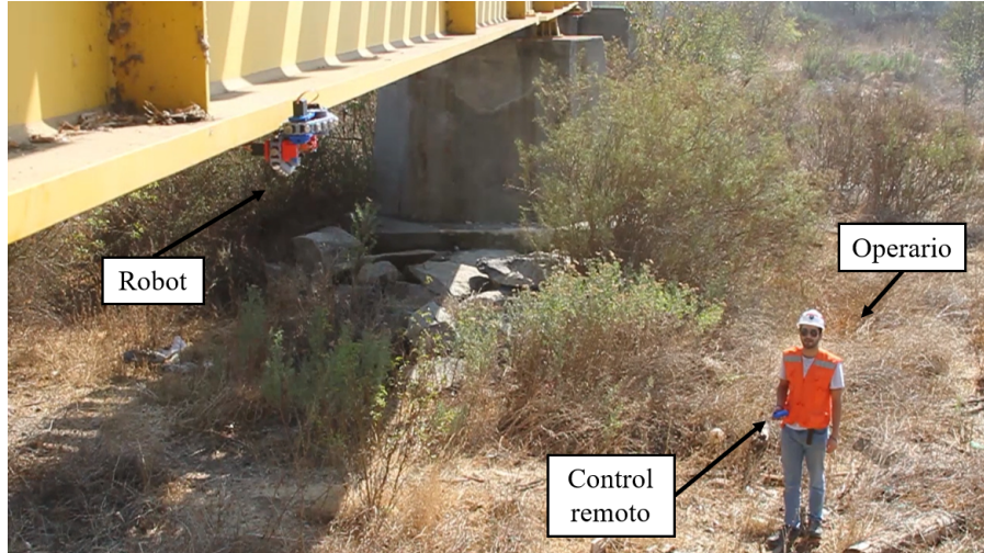
Figura 6.19: Operario manejando el robot a distancia. Aproximadamente a unos 35 [m] del dispositivo.
