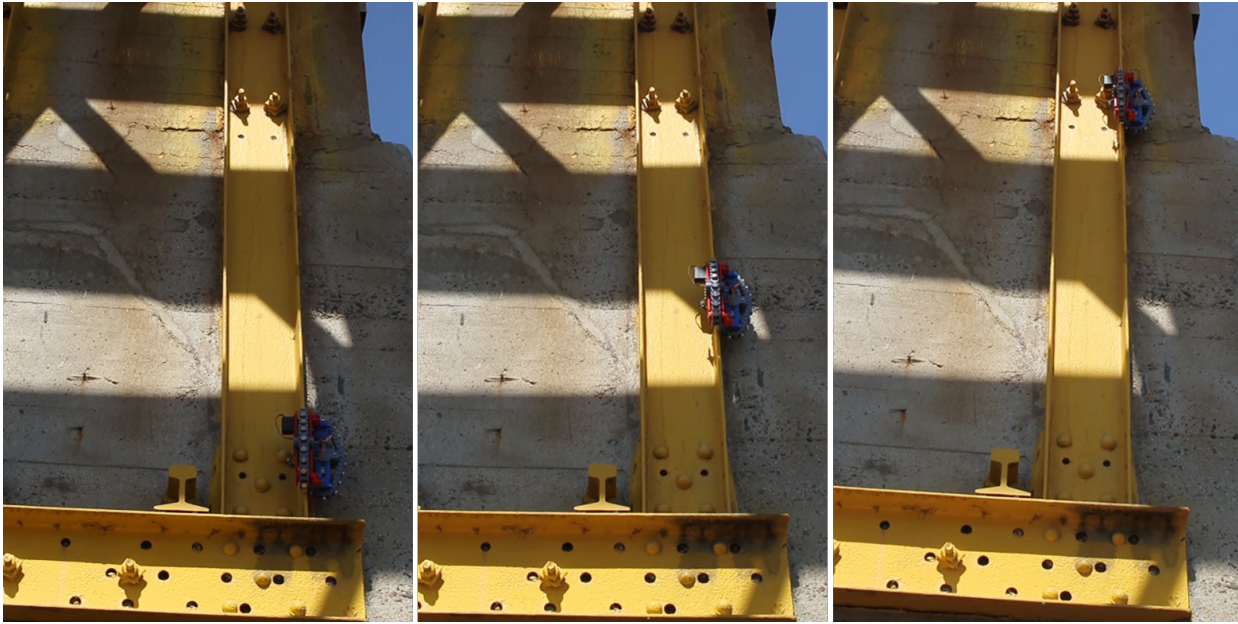
Figura 6.18: Transición de movimiento del robot sobre superficie vertical en cepas del puente. El grosor de las barras es de 10[mm].
