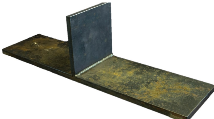
Figura 4.8: Viga con refuerzo soldado en T
