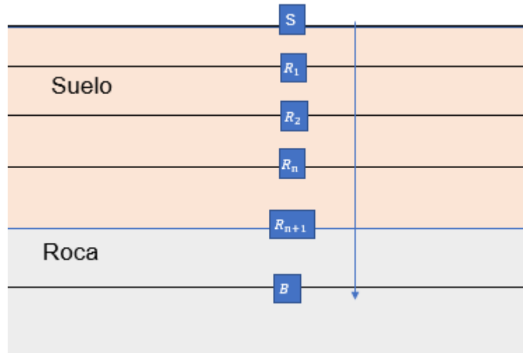
Figura 3.5: Representación de la variación del sitio de referencia para la obtención de la función de transferencia teórica en profundidad. S representa el sensor en superficie, mientras que B el sensor en profundidad. R representa el lugar de referencia, el cual fue ubicado cada 2 metros en los primeros 10 metros de profundidad, para luego ir ubicándolo cada 10 metros, hasta llegar a la ubicación del sensor en profundidad B.
