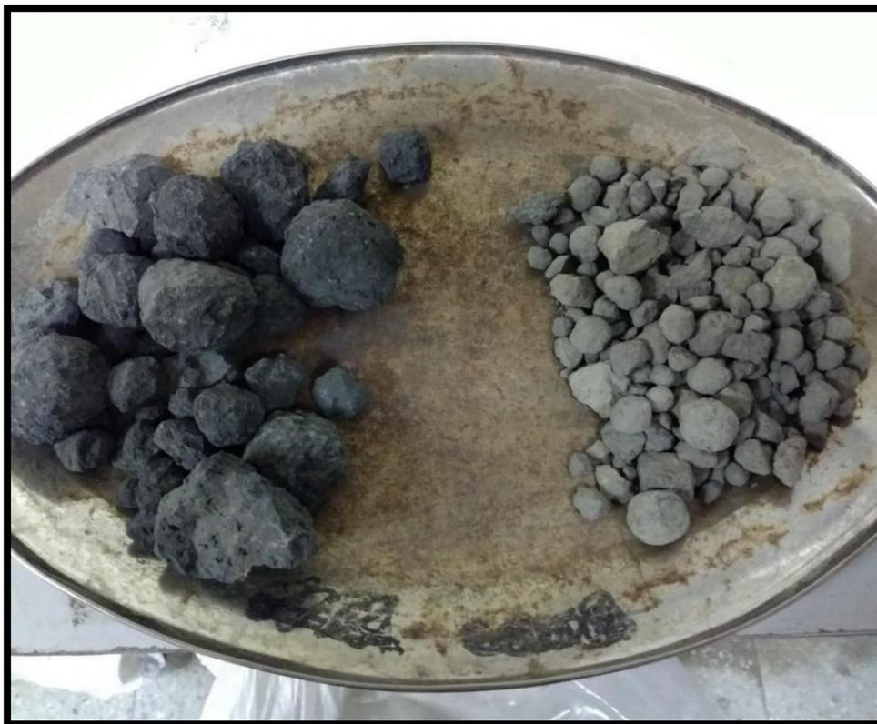
*Figura 37: Comparación de un clínker obtenido (derecha) y un clínker comercial (izquierda).*
