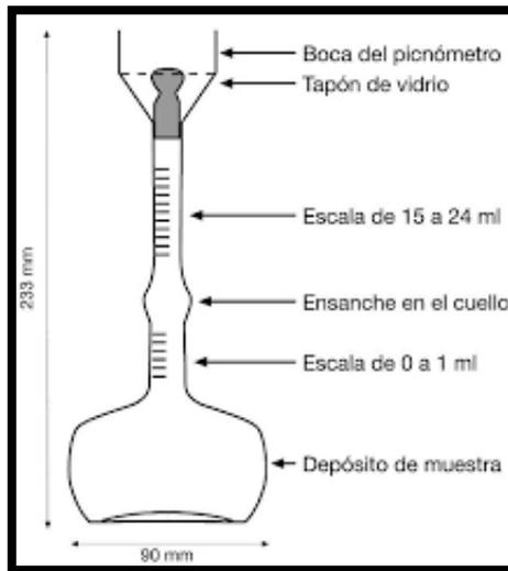
Figura 50: Diagrama de un matraz de Le Chetelier [49]
