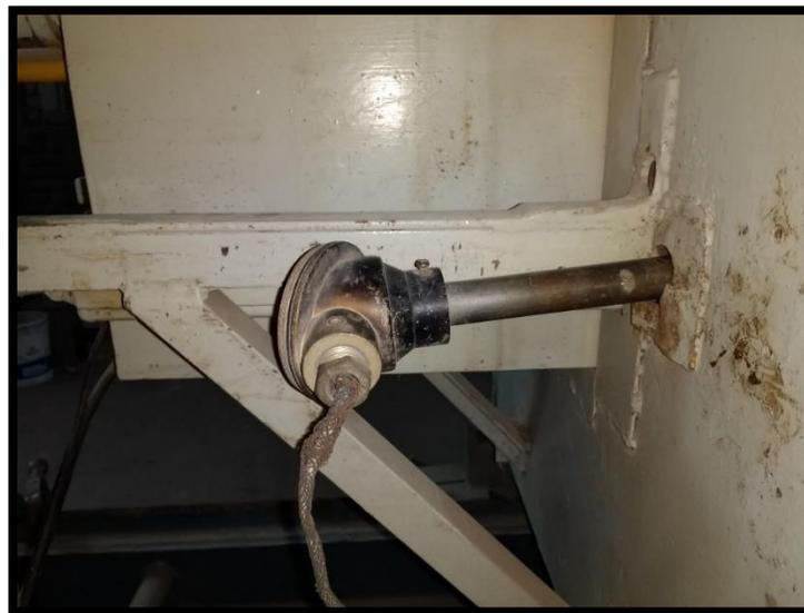
*Figura 29: Posición de la termocupla tipo K en el horno*
