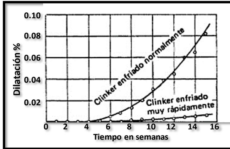
Figura 11: Dilatación del cemento según su velocidad de enfriamiento[19]
