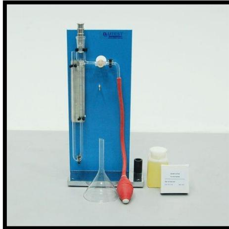
Figura 51: Equipo para ensayo de permeabilidad según Blaine [50]
