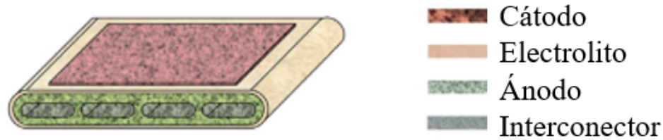
Figura 2.6: SOFC de Diseño Plano-Tubular [8]
