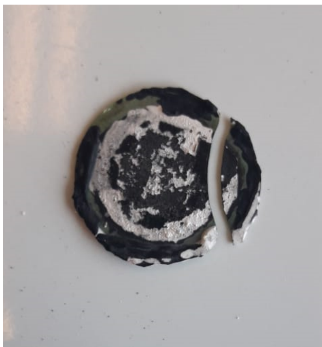
Figura 5.1: Estado Final Celda LSCF
