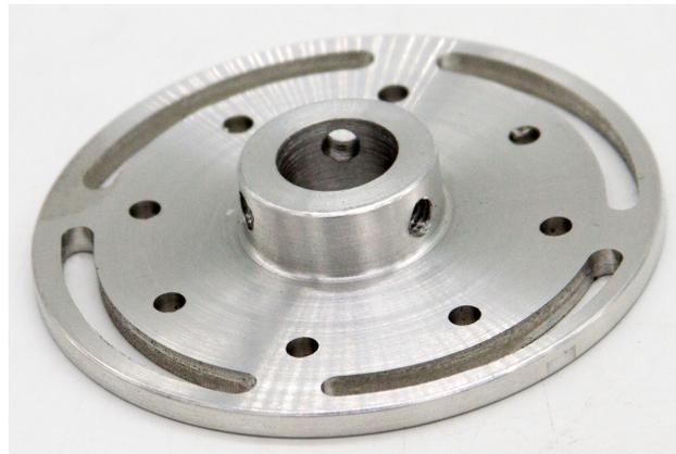
Figura 4.7: Fotografía de un módulo; posee 8 agujeros para pasar cables en la base, y 3 agujeros con hilo en la parte superior donde van prisioneros que permiten fijar el módulo al resorte principal.
