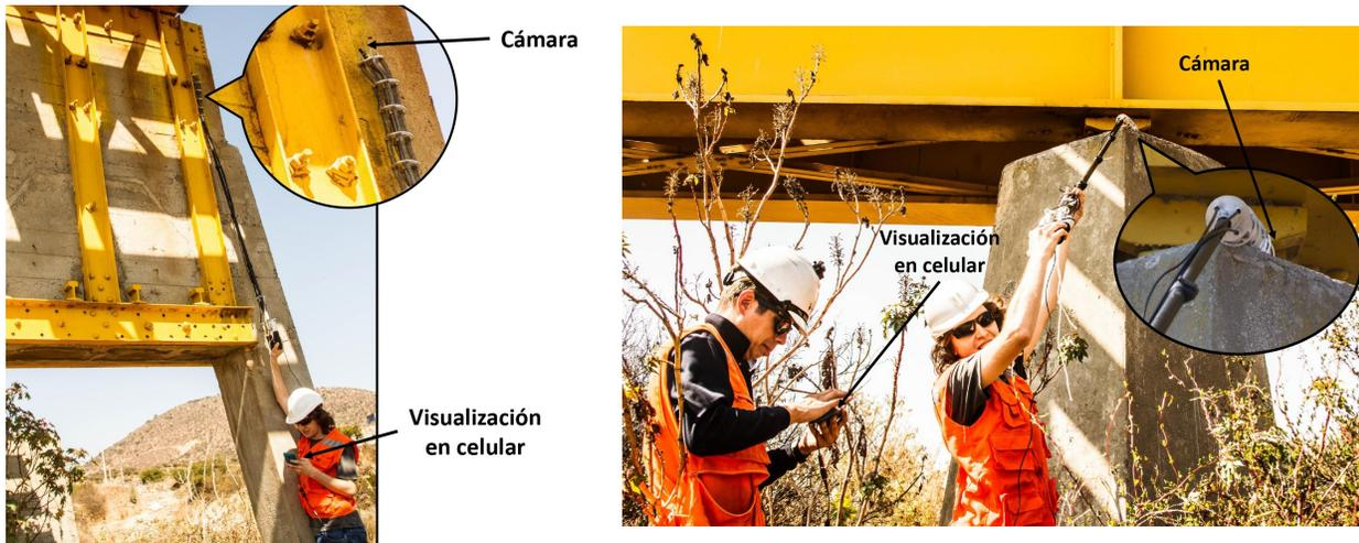
Figura 5.20: Manipulación desde abajo del puente.
