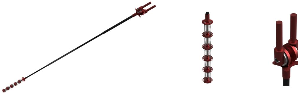
Figura 4.25: Diseño final CAD del brazo completo, manipulador de cargas y controlador del manipulador
