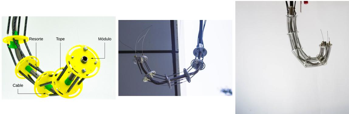
Figura 4.5: Evolución en el diseño flexible del manipulador de cargas; A la izquierda se ve el manipulador en su etapa inicial, los módulos son de PLA y se fijan al resorte con cinta adhesiva. Al centro, el manipulador ya con los módulos en su versión definitiva de duraluminio. A la derecha, la versión final dónde están añadidos los resortes secundarios.
