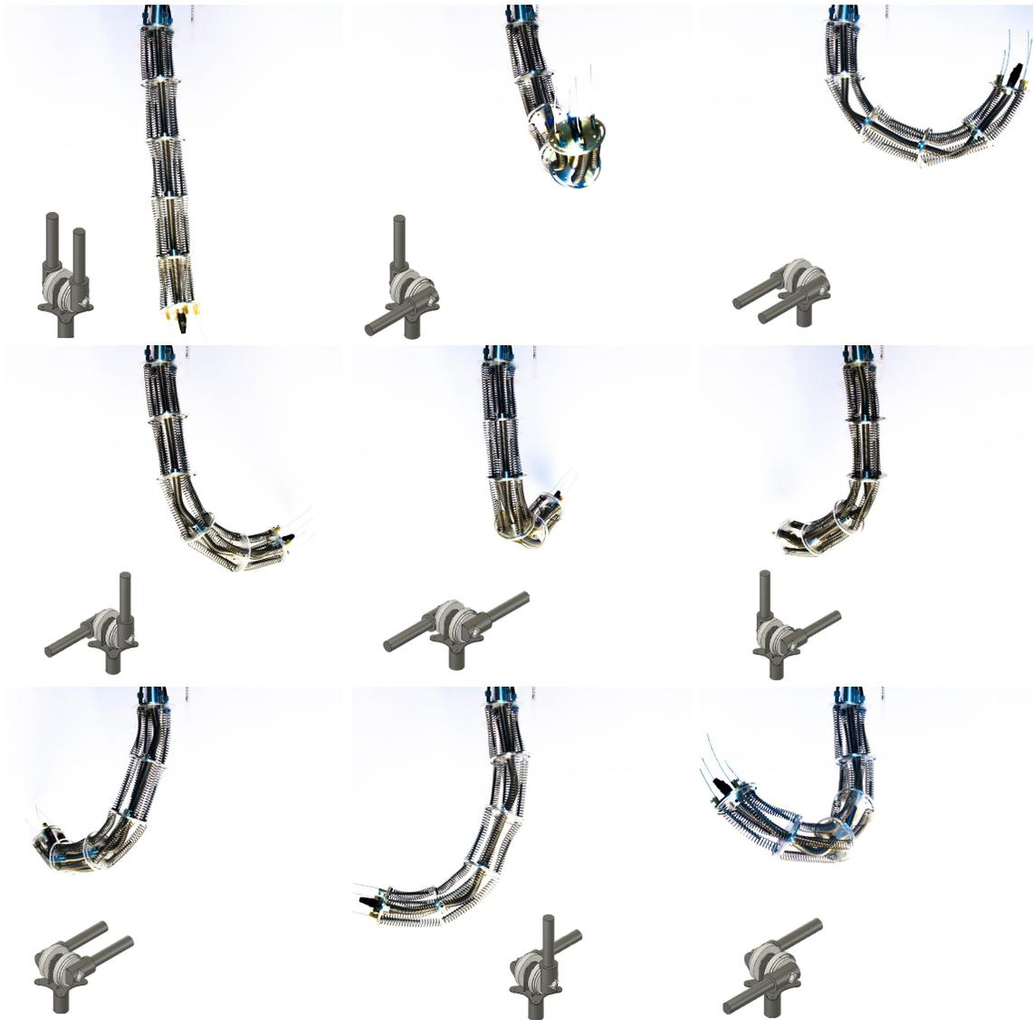
Figura 5.8: Posiciones límites alcanzada por el manipulador de cargas, vista lateral; En cada una de las posiciones se aprecia la posición del controlador para tener al manipulador en esa posición.
