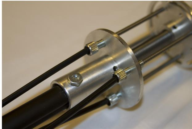
Figura 4.11: Fotografía del acople; se ve como el acople logra unir la estructura principal desplegable con el manipulador de cargas.
