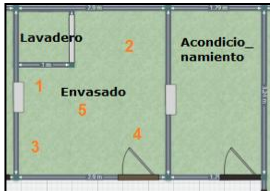
Figura 40: Puntos de medición sala de envasado
