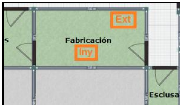
Figura 26: Inyector y extractor de sala.
