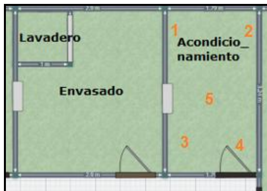
Figura 46: Puntos de medición sala acondicionamiento
