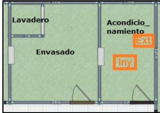
Figura 44: Inyector y extractor sala acondicionamiento
