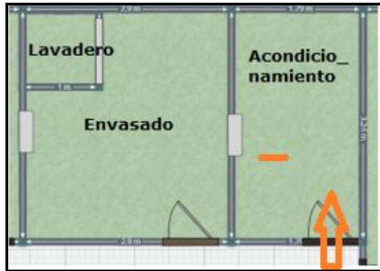
Figura 45: Diferencia presión sala acondicionamiento
