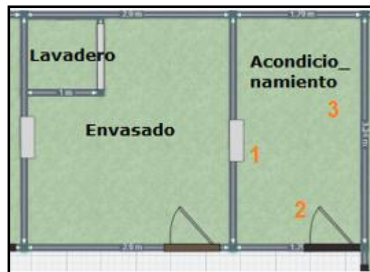
Figura 43: Puntos medición sala de acondicionamiento
