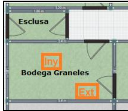
Figura 30: Inyector y extractor sala.
