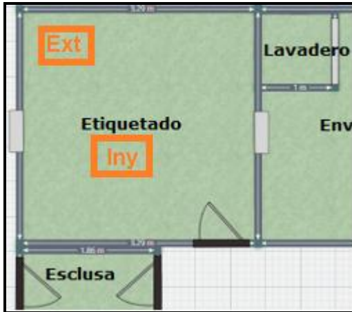
Figura 34: Inyector y extractor sala.
