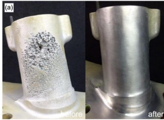
Figura 2.6: Reparación caja engranaje helicóptero. Fuente: [2]
