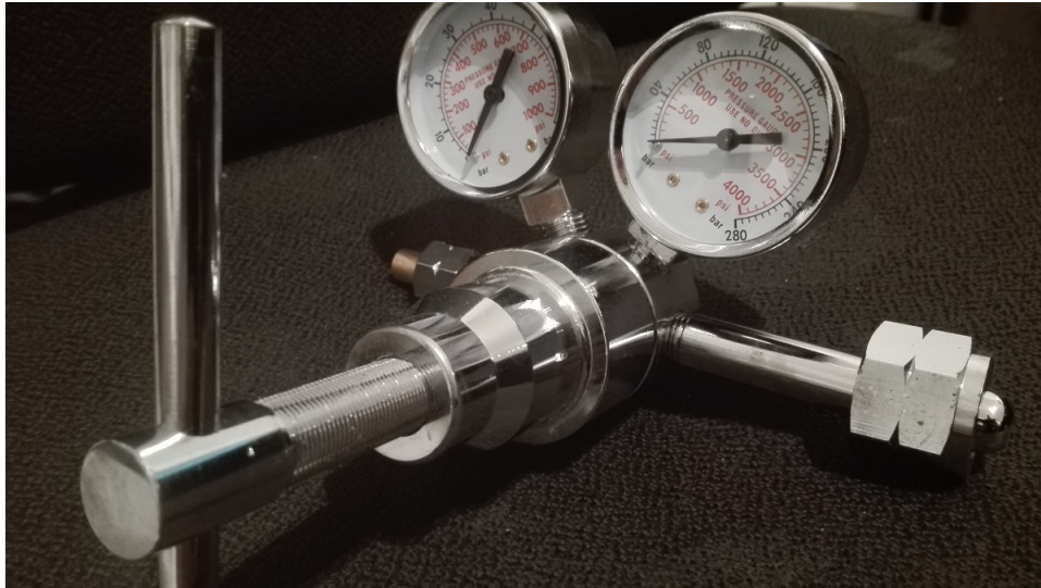
Figura 6.3: Regulador presión alta nitrógeno. Fuente: Elaboración propia
