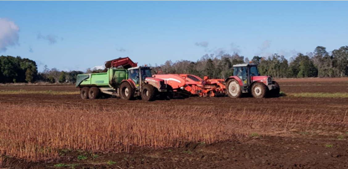
Figura 15.3: Máquina cosechadora descargando los bulbos a un carro de arrastre. Fuente: Obtención propia en predio de la empresa.
