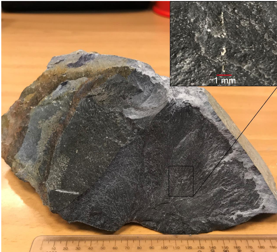
Figura 4.17. Microgabro con magnetita y piritita diseminada y en vetillas, con un tamaño menor o igual a 0,5 mm de ancho.
