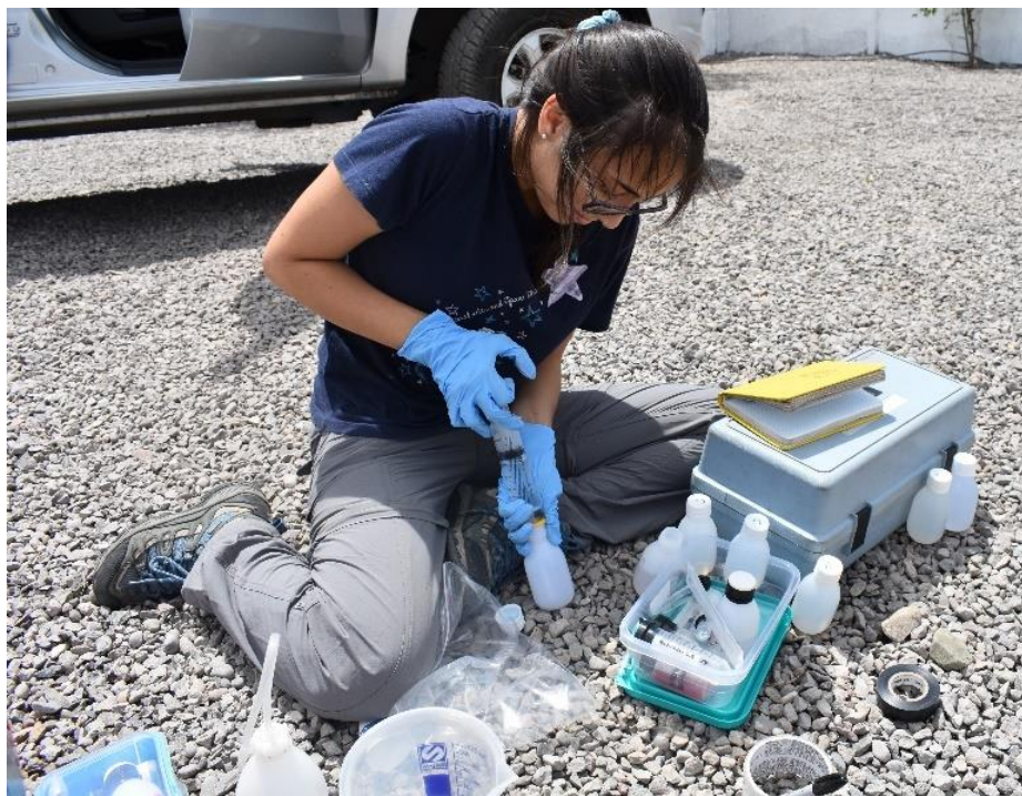
Figura 2.3 Toma de muestras de agua para cationes, aniones, elementos trazas e isótopos estables.
