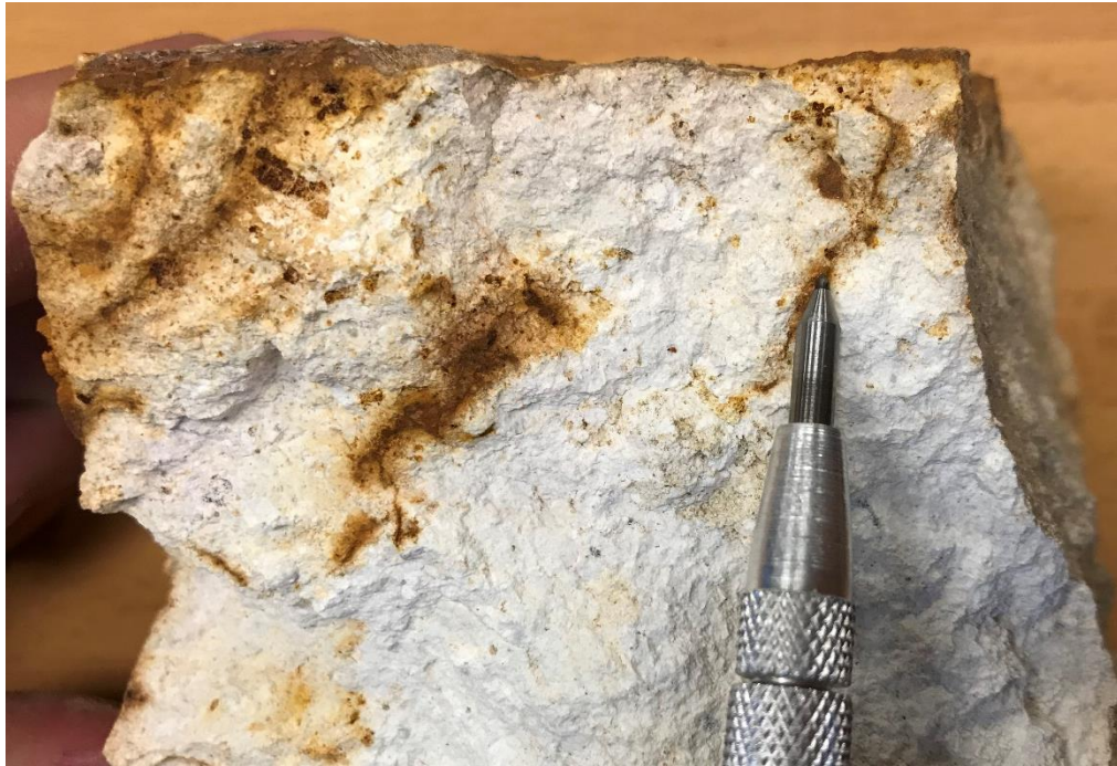
Figura 4.20 Muestra alterada totalmente a arcillas con boxwork y óxidos.
