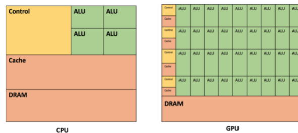
Figura 5.1: Comparación simplificada de arquitecturas CPU y GPU (adaptada de [9]).
