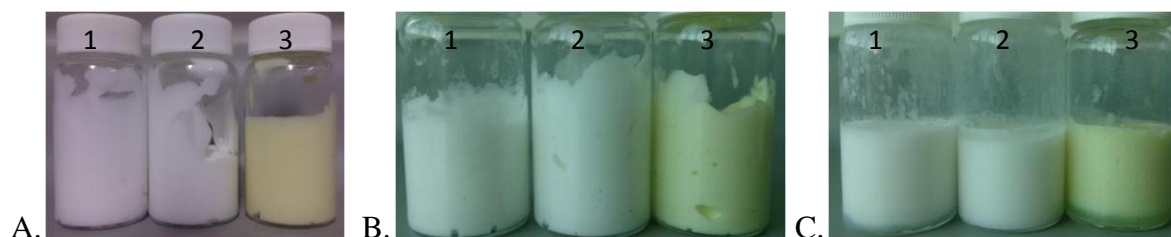
Figura 14. Fotografías de emulsiones preparadas con 100 % de tensoactivo (1), con 50 % de tensoactivo y 4 % de AMNPs (2), con 50 % de tensoactivo y 4 % de AMNPs-MOR. A) Emulsiones recién preparadas. B) Emulsiones almacenadas a temperatura ambiente, luego de dos meses. C) Emulsiones almacenadas a 40 C luego de dos meses.
