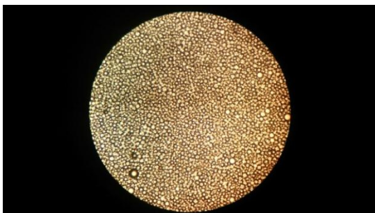
Figura 9. Imágenes de microscopía óptica de emulsiones aceite mineral/agua con diferentes concentraciones de AMNPs recién preparadas.
