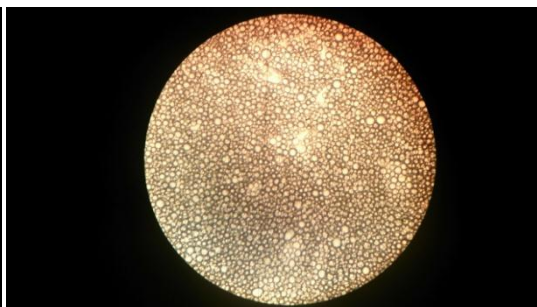
Figura 9. Imágenes de microscopía óptica de emulsiones aceite mineral/agua con diferentes concentraciones de AMNPs recién preparadas.
