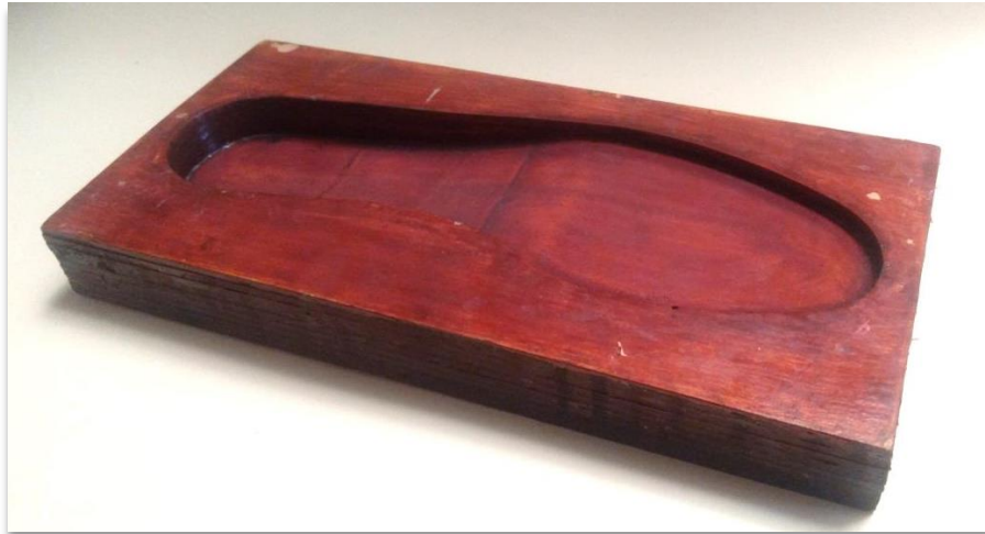
Figura 68: Elaboración de molde de planta. Elaboración propia
