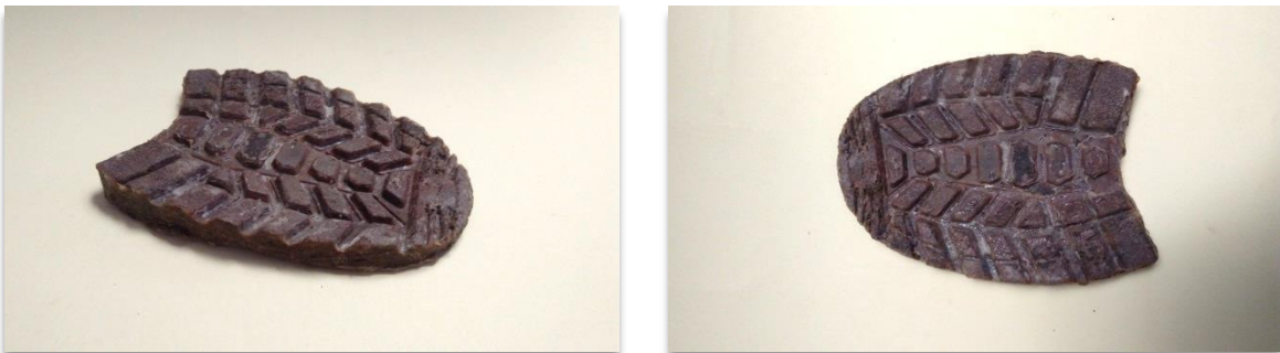
Figura 58: Resultados de moldeo de sobre relieve. Elaboración propia
