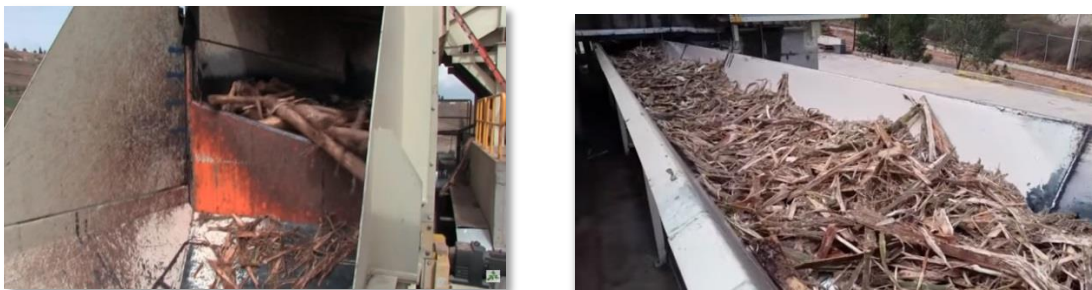
Figura 6: Proceso de descortezado (Forestindustria, 2015)
