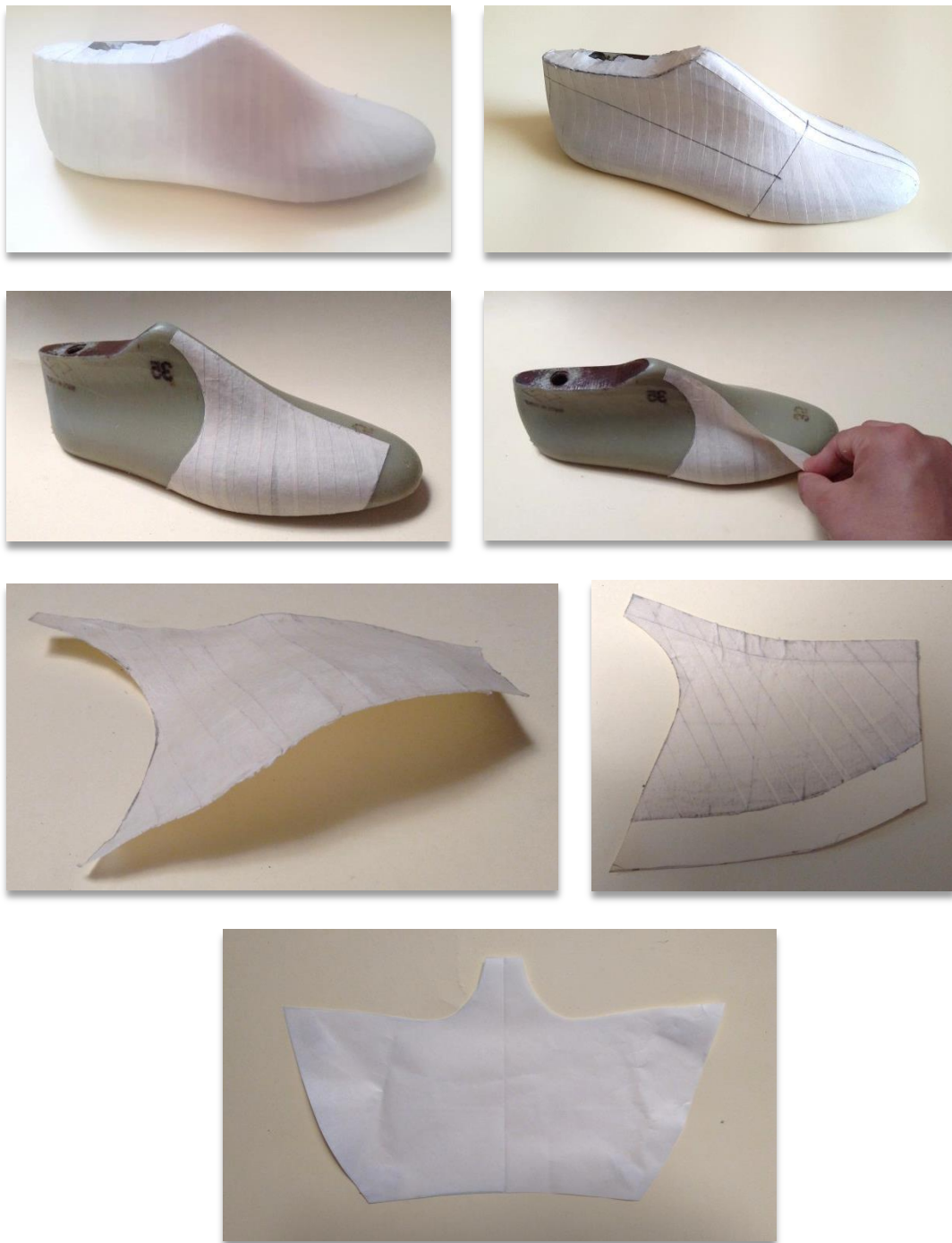
Figura 67: Elaboración de molde de capellada. Elaboración propia
