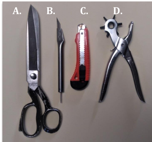
Figura 35: Herramientas de corte y perforado. A. Tijera de sastre. B. Cuchillo zapatero de precisión. C. Cuchillo cartonero. D. Sacabocado. Elaboración propia
