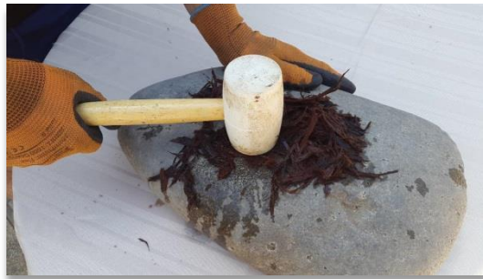
Figura 40: Resultado proceso de batido. Elaboración propia
