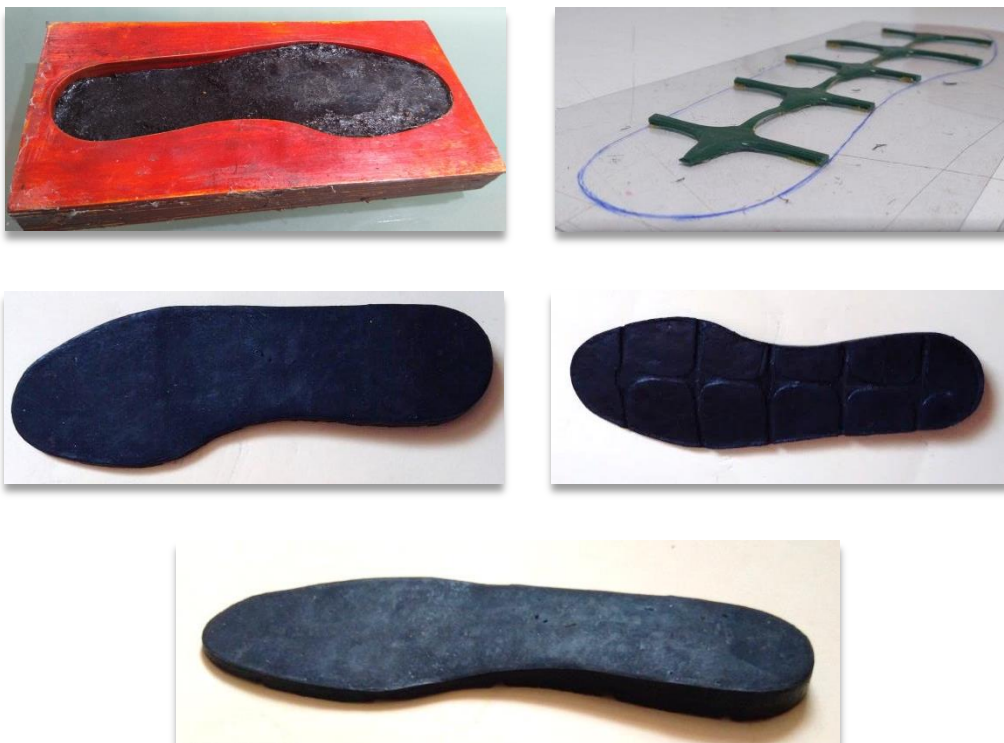
Figura 69: Moldeo de planta. Elaboración propia
