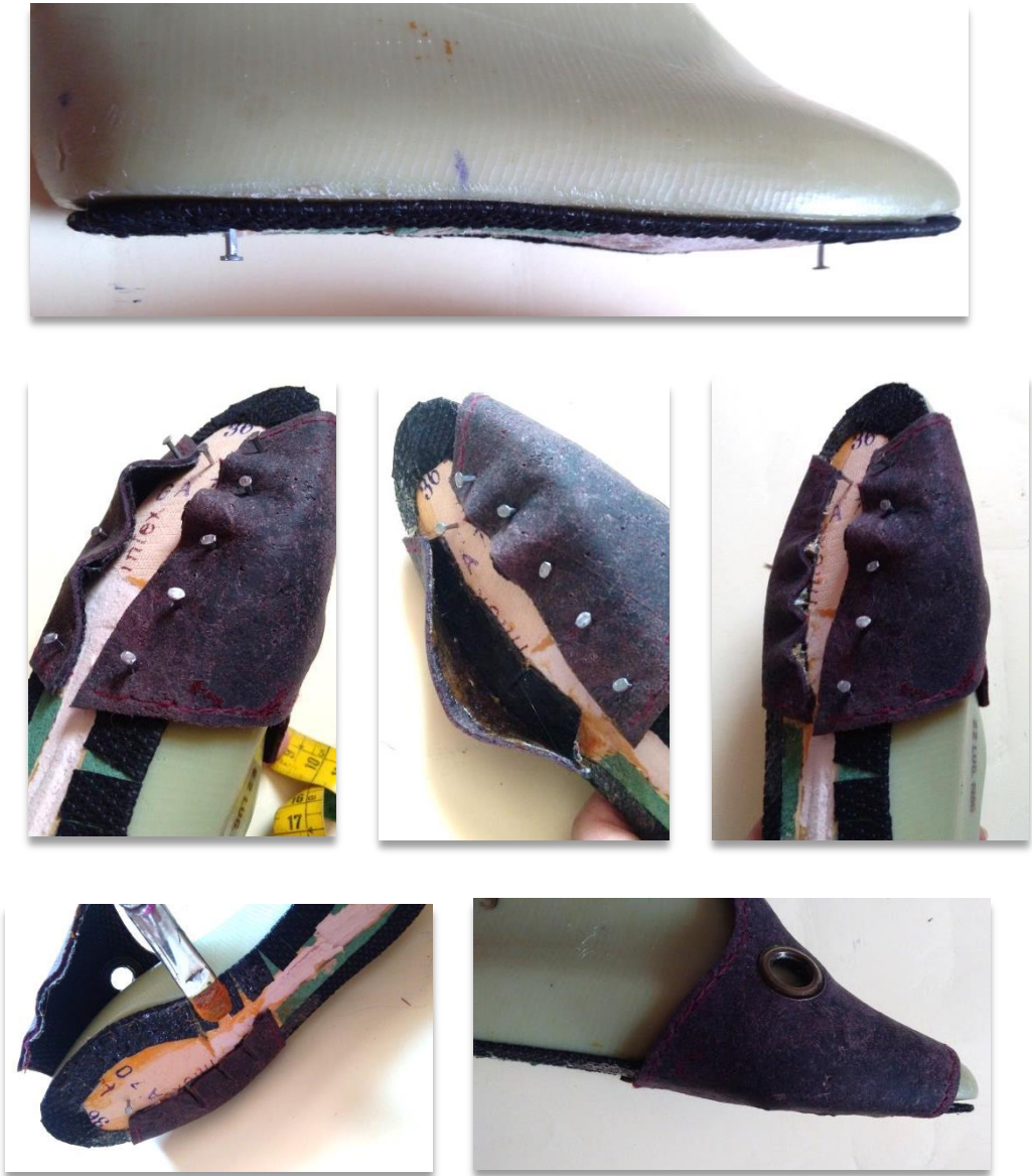
Figura 73: Aparado del calzado. Elaboración propia
