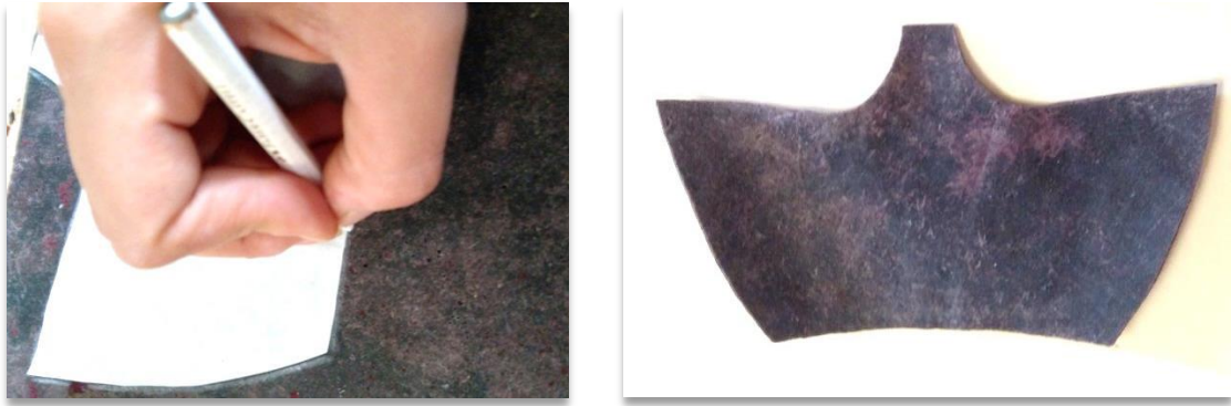
Figura 70: Corte de capellada. Elaboración propia
