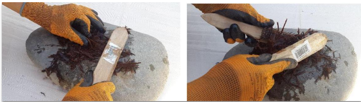
Figura 41: Resultado proceso de cardado. Elaboración propia
