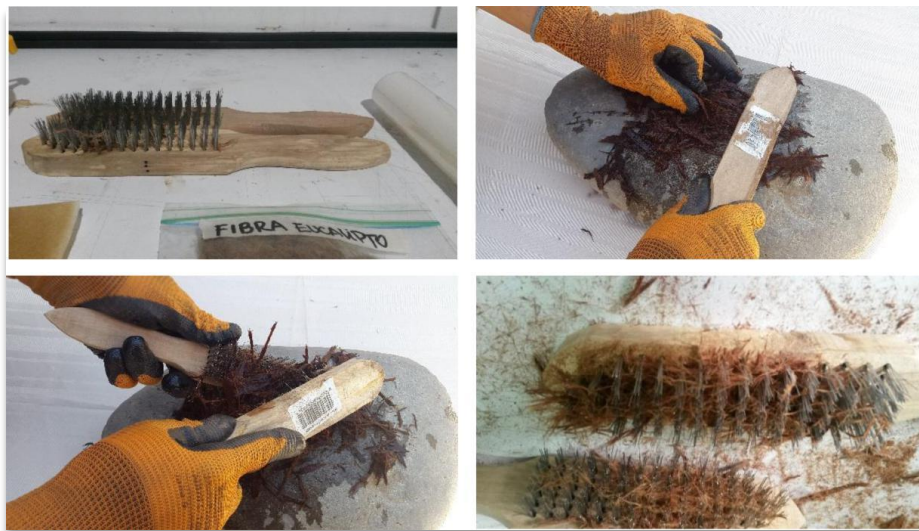
Figura 27: Proceso de cardado. Elaboración propia
