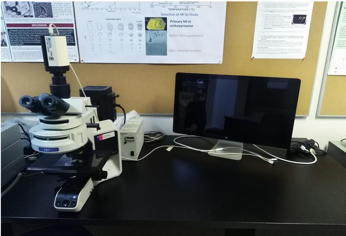
Figura 15: Microscopio Olympus BX53, conectado con Linkam THN-600. Universidad de Chile.
