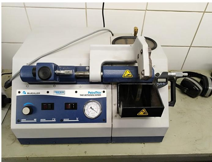
Figura 14: Máquina PetroThin utilizada para preparar los cortes de roca.
