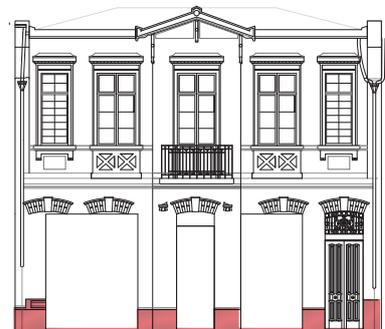
El zócalo en general presenta un mal estado de conservación. Desprendimientos de material, erosión y humedad se encuentran a lo largo de todo el inmueble, afectando la terminación e incluso el interior del material constructivo, en muchas áreas a expuesto a la intemperie.
