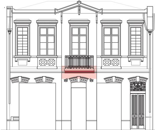
Otro de los problemas peligrosos que presenta la edificación son los balcones presentes en todos los módulos, los cuales poseen daños estructurales de losa de hormigón, corrosión en la estructura de acero y barandas y daños a la estructura portante de la edificación ocasionados por la mala instalación, el apoyo y el peso propio del saliente.
