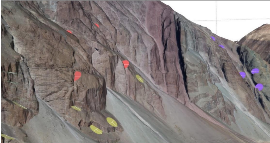
Figura 33. Vista hacia el Sur de las fracturas mayores en la zona Este. En amarillo el set 1, verde el set 2, en rojo el set 3, en gris el set 4 y en morado el set 5. Tomado de Pairoa (2018).
