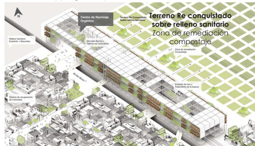
Luego, un porcentaje del compost generado se usa para la producción de huertas orgánicas dentro del edificio o en viviendas cercanas. Por último, una fracción de la basura que ingresa es colocada en tres digestores que se encargan de aprovechar el gas metano liberado en la descomposición y transformarlo en energía para autoabastecer el proyecto.
