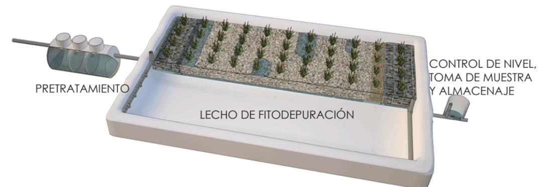
Sistema de fitodepuración subsuperficial convencional. Catálogo Ecodena. Depuración Industrial. Fuente: <http://www.ecodena.com.pe>
