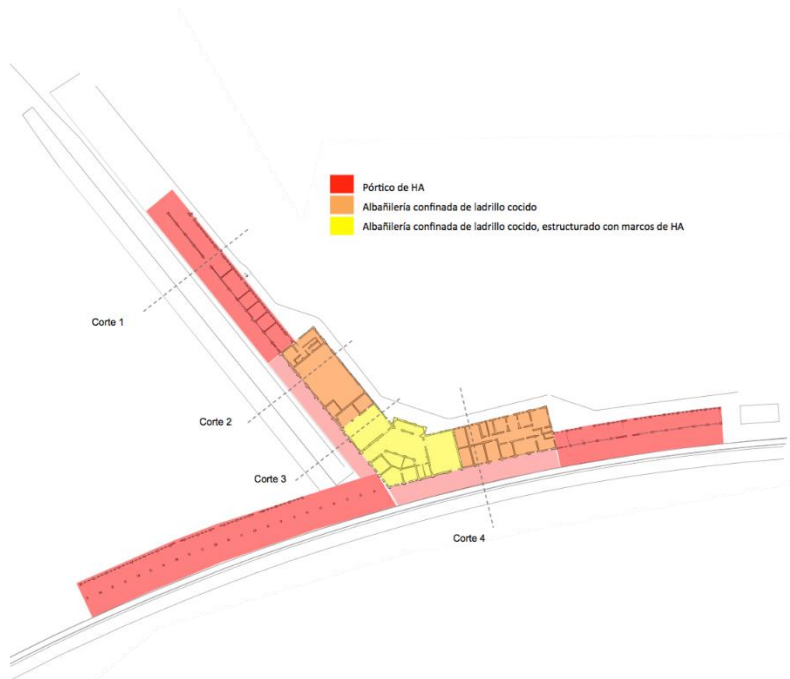
Imagen 03: Planta ubicación de los sistemas constructivos (fuente: Expediente técnico Universidad de Chile 2014)
