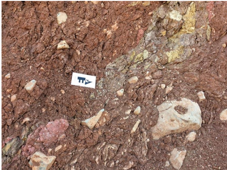
Figura 4.3.10: Afloramiento de facies de flujo, se observa la poca consolidación de roca.
