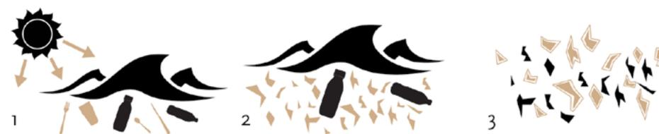
Imagen 2. Esquema generación del microplástico a través de fotodegradación y movimiento de las olas. Elaboración propia.
