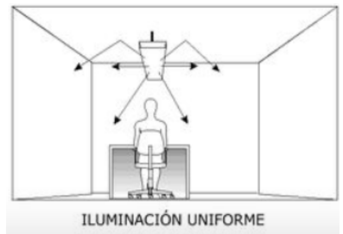
FIG. 49. Esquema de fuentes de luz uniforme. Fuente de: Piñeda.A. Montes.G. Ergonomía ambiental: iluminación y confort térmico en trabajadores de oficinas con pantalla de visualización de datos. (2014).
