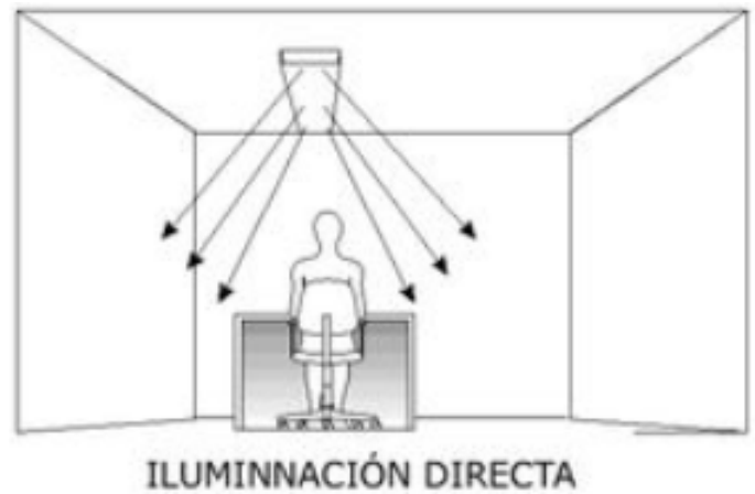
FIG. 47. Esquema de fuentes de luz directa. Fuente de: Piñeda.A. Montes.G. Ergonomía ambiental: iluminación y confort térmico en trabajadores de oficinas con pantalla de visualización de datos. (2014).
