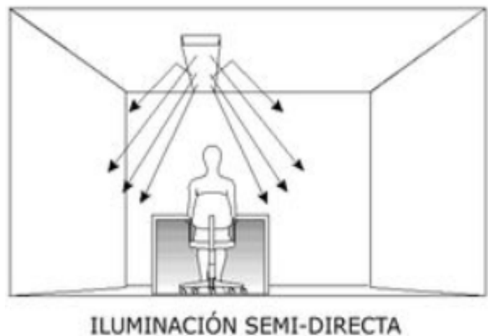
FIG. 48. Esquema de fuentes de luz semi directa. Fuente de: Piñeda.A. Montes.G. Ergonomía ambiental: iluminación y confort térmico en trabajadores de oficinas con pantalla de visualización de datos. (2014).
