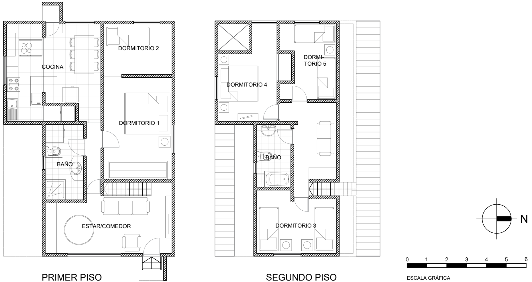
Figura 89: Levantamiento planimétrico vivienda de Noemí. Vivienda con alto grado de transformación donde no se reconoce claramente el modelo de la vivienda original. Fuente: elaboración propia 2019.
