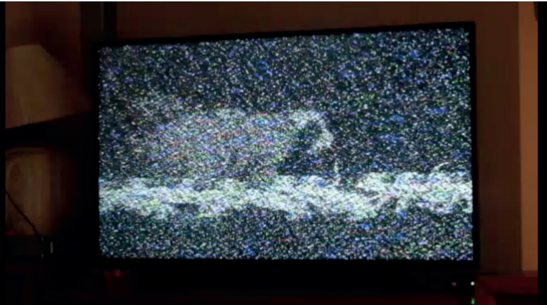
Figura 7. Antena en posición horizontal; ambos tubos en posición. Distancia: 7,5 Mts. Abajo reacción del televisor
