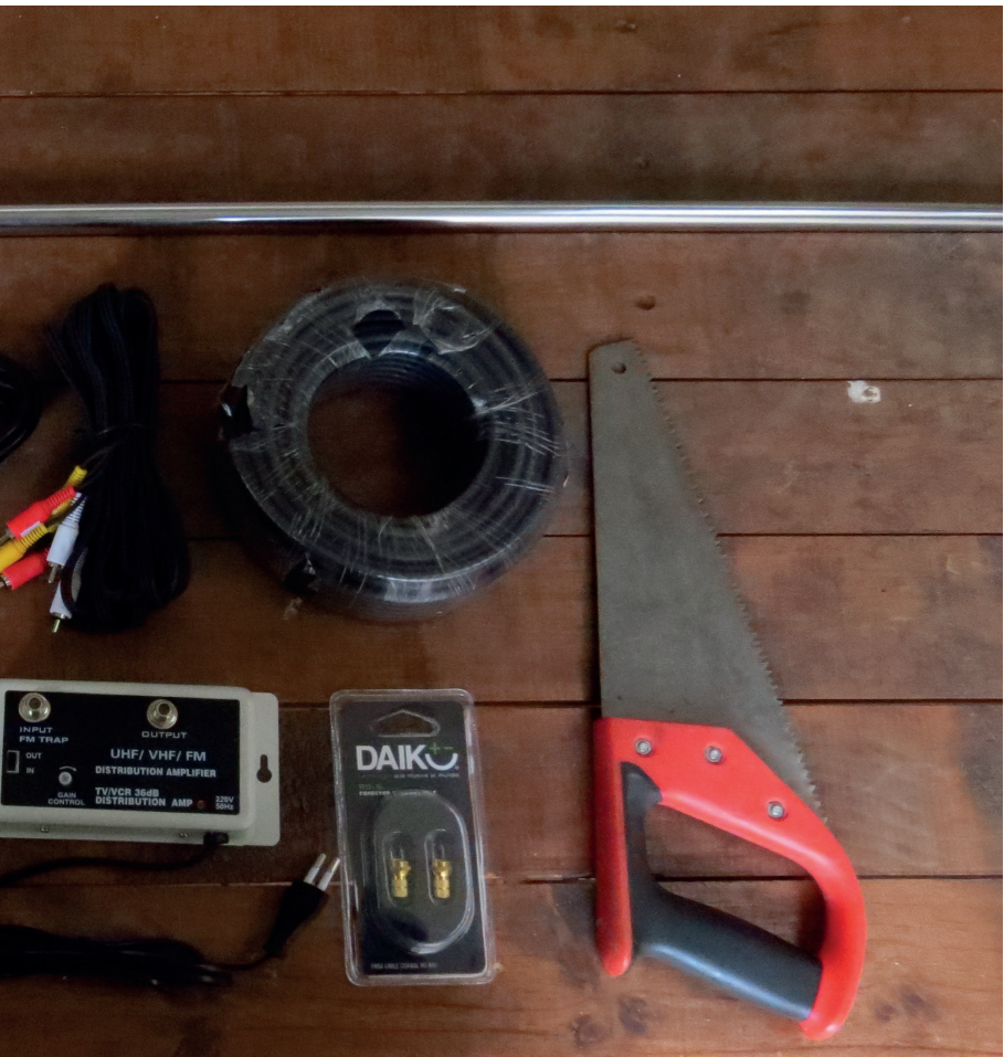
Figura 2. Serie de herramientas y materiales utilizados para armar el sistema de Transmisión, entre las fotografías de arriba se encuentran el amplificador de radiofrecuencia, el coaxial RG6 y sus adaptadores, junto al cable VGA
