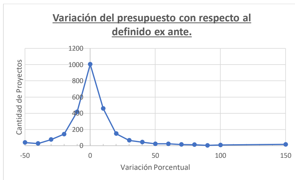
Figura 25: Variación del costo real del proyecto con respecto al presupuesto estipulado ex ante.
