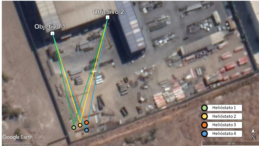
Figura 4.26: Disposición de heliostatos de prueba y superficies objetivos
