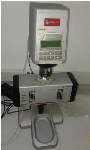
Figura 4.1: Reómetro rotacional Rheolab QC Anton Paar.
