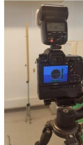
Figura N° 13: Sensor de nivel electrónico integrado en la cámara (giroscopio), usado para obtener una correcta orientación de la fotografía (Foto tomada por Avio D, 2017).
