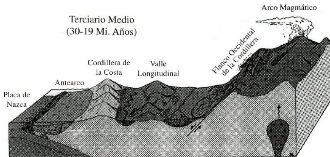
Figura 16: Perfil geológico esquemático del norte de Chile con sus unidades más importantes. La escala no está determinada (Seyfried et al, 1998a).
