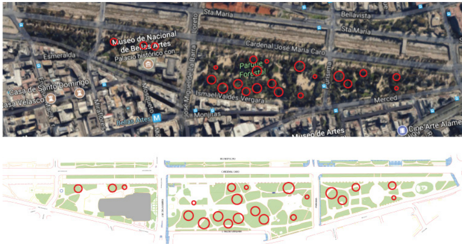
Imagen 164. Ubicación propuesta de luminaria nueva. Elaboración propia.
