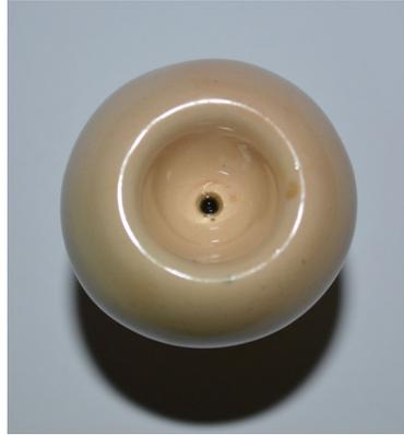
Fig. 73 Quemador semi-esférico tras un mes de uso frecuente, luego de una limpieza con alcohol gel.
