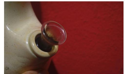
Fig. 69. Calce correcto con quemador genérico de 14 mm
