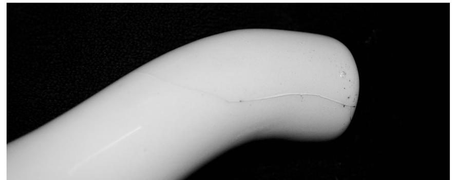
Fig. 62. Prototipo Quimera de 3,5 mm de espesor con trizadura en el esmalte en la zona de la boca
