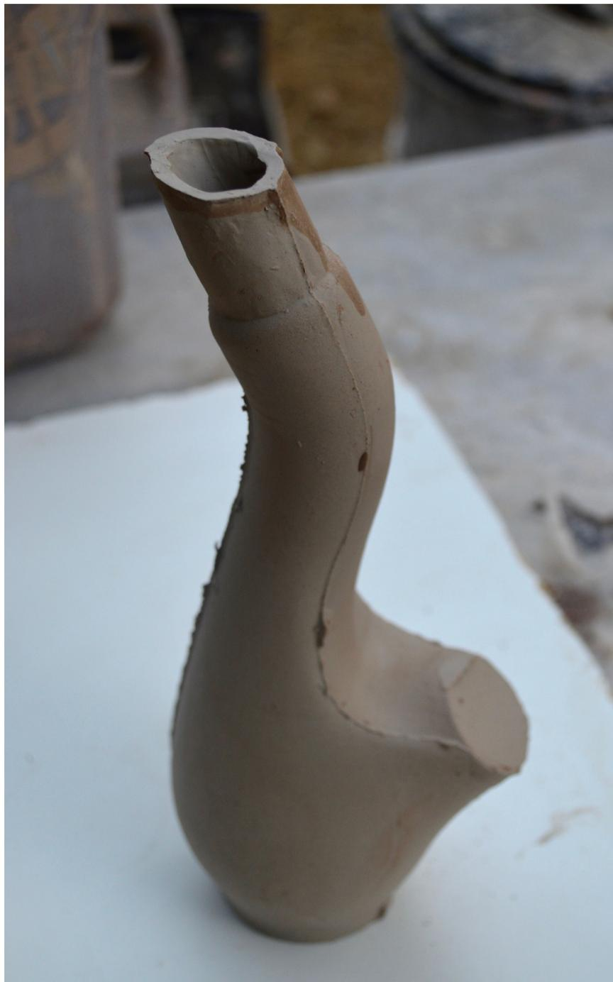
*Fig 80. Pieza en estado de cuero recién salida del molde*
