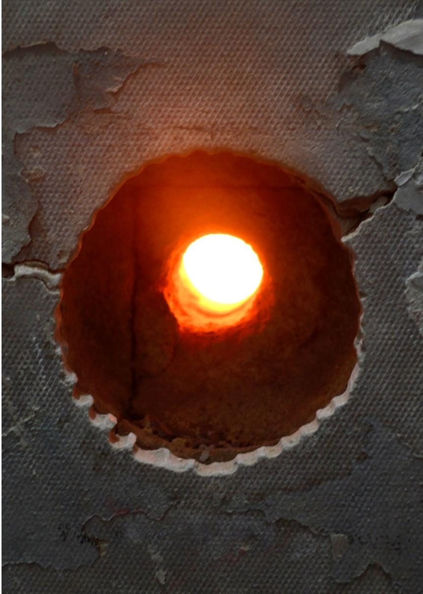
*Fig 86. Mirilla del horno cerámico con piezas en proceso de cocción ( 960º)*
