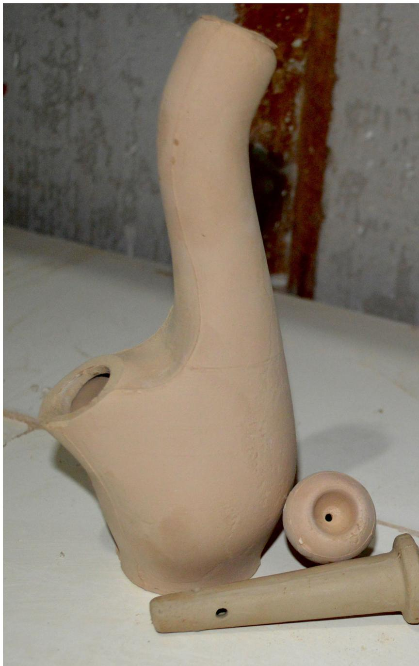
Fig 83. Cuerpo de la pipa, difusor y quemador en proceso de secado
