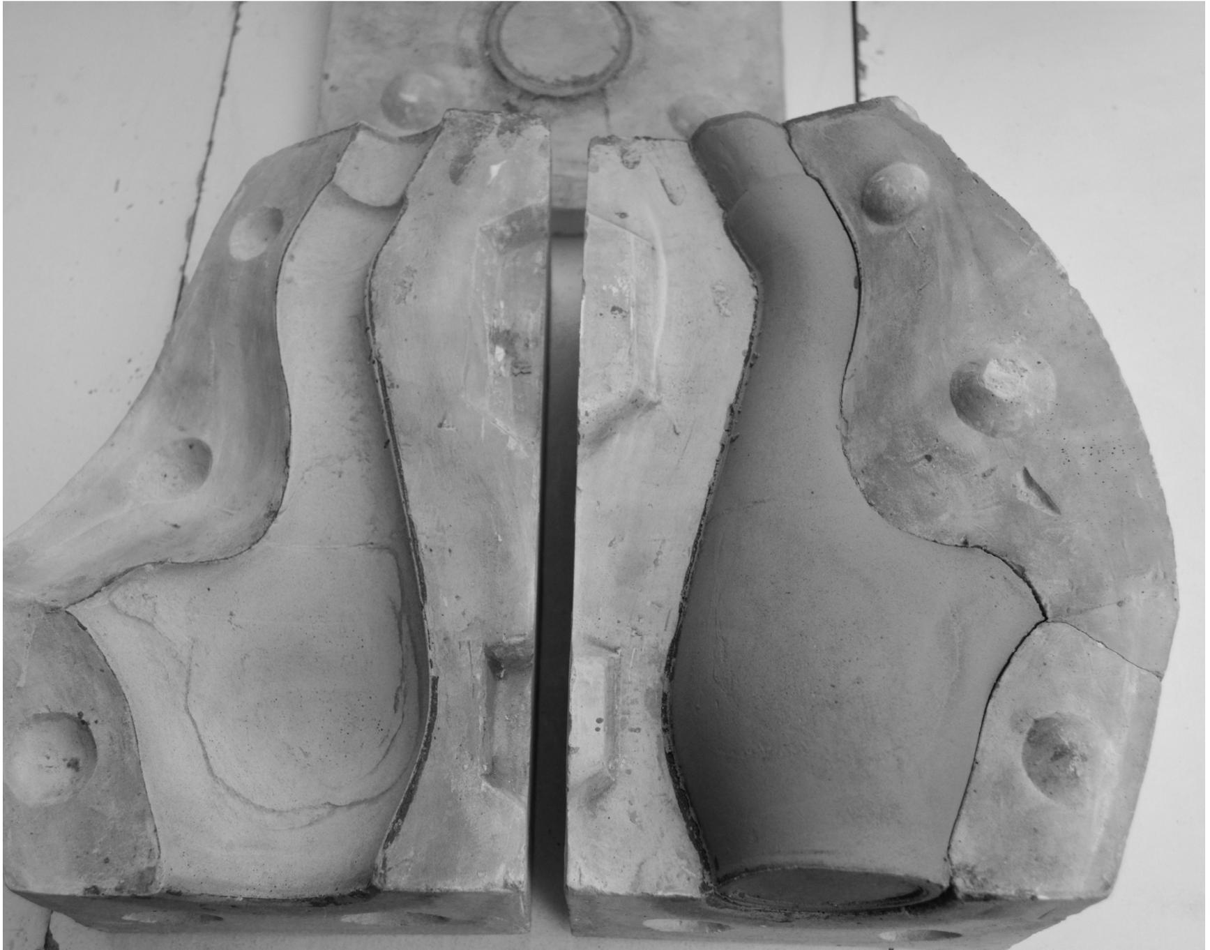
*Fig 78. Apertura del molde con la pieza vaciada en su interior*
