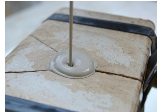
Fig 77. Proceso de vaciado en pasta colada/ Elab. propia
