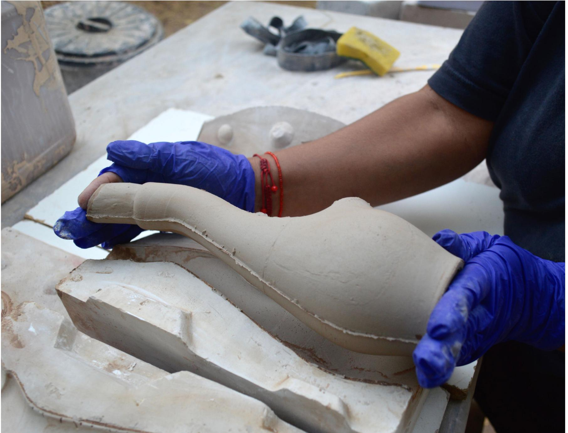
Fig 79. Desmolde de la pieza desde el interior del molde
