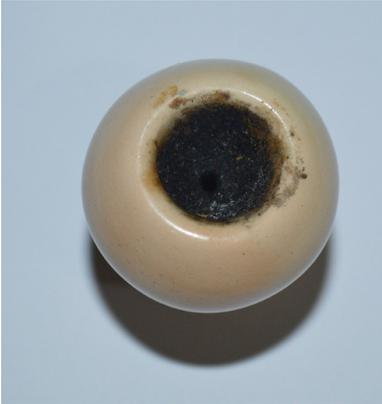
Fig. 72. Quemador semi-esférico tras un mes de uso frecuente
