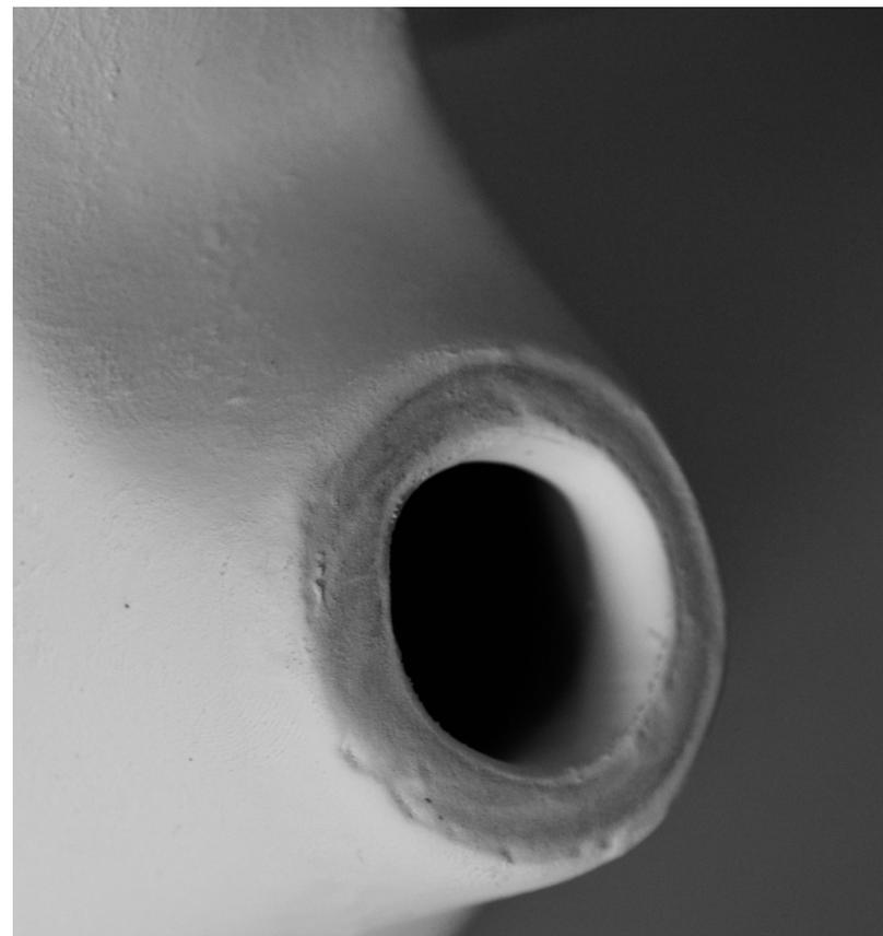
*Fig 91. Limpieza del esmalte en la entrada del difusor*
