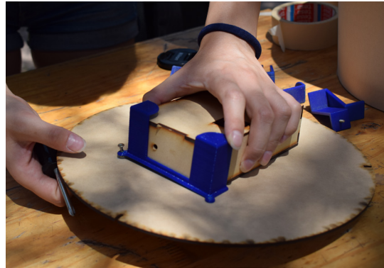
Foto 108: Instalación de datalogger a tapa de prototipos. Elaboración propia.
