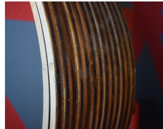
Foto 129: 13 costillas unidas con tarugos a la vista. Elaboración propia.
