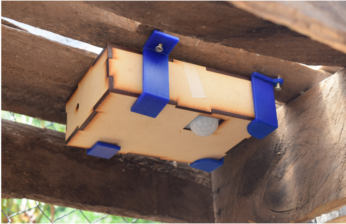
Foto 69: Caja con datalogger instalada. Elaboración propia.
