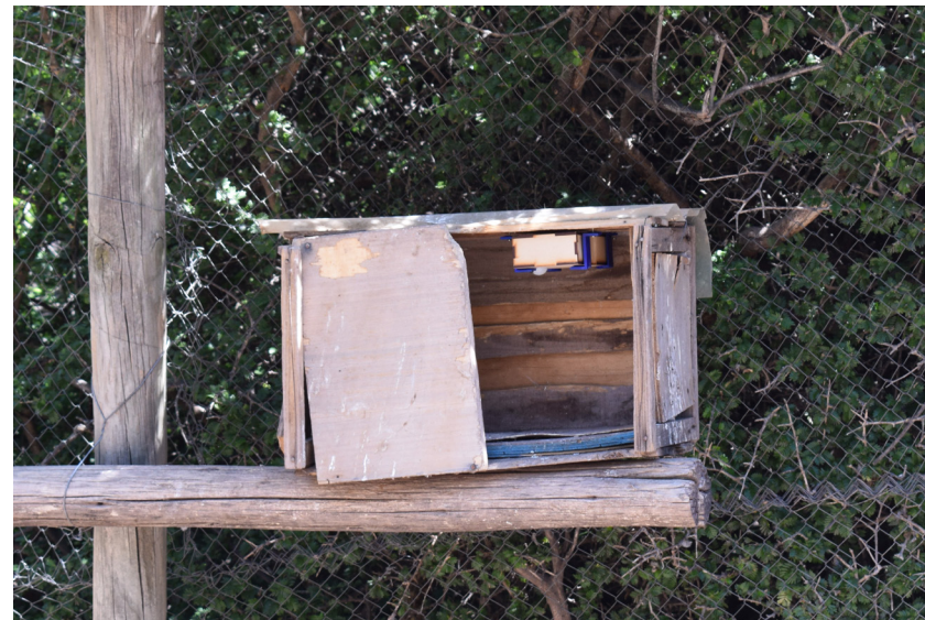
Foto 66: Habitáculo con datalogger 3. Elaboración propia.
