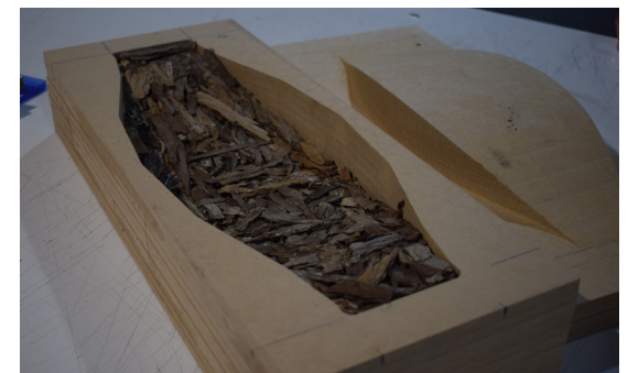
Foto 124: Corteza + pva en molde. Elaboración propia.
