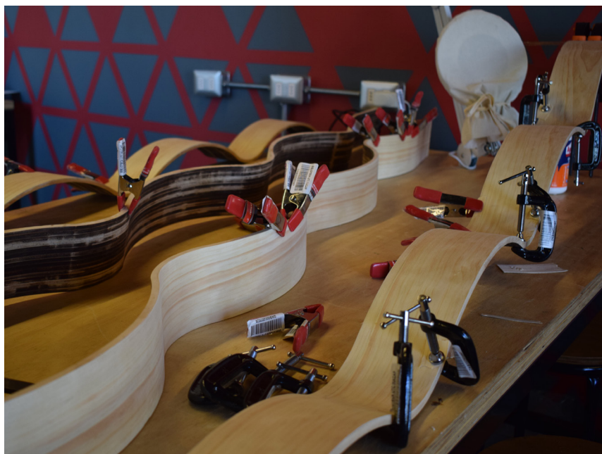
Foto 131: Fijación de bordes despegados. Elaboración propia.
