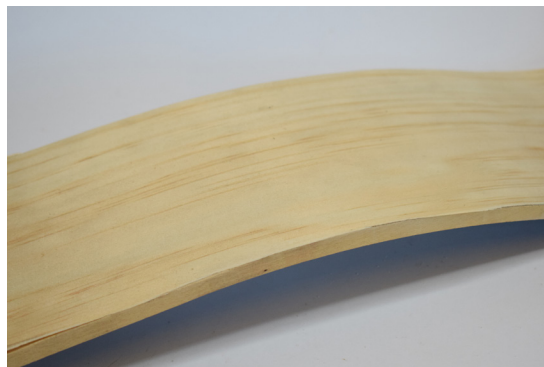
Foto 135: Prueba de pegado de chapa. Elaboración propia.
