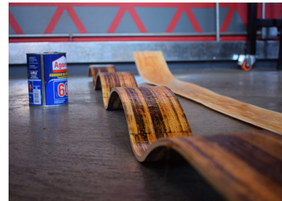
Foto 130: Superficies con agorex 60 a punto de ser pegadas. Elaboración propia.
