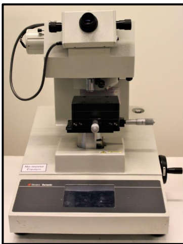
Figura 3. Imagen del microindentador de Vickers Struers Duramin (USA). Instrumento utilizado en la medición de dureza superficial de las muestras de esmalte.
