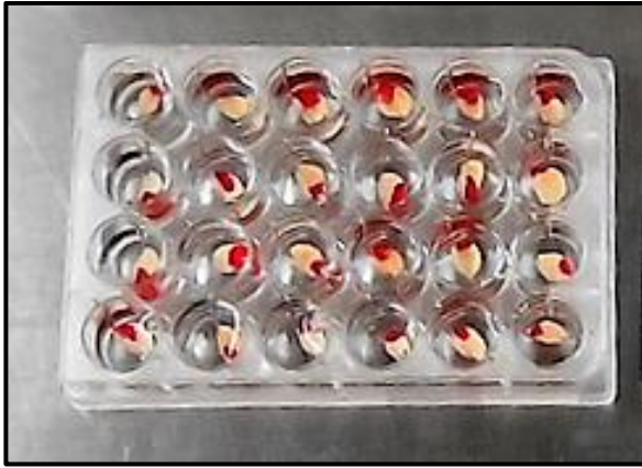
Figura 9. Imagen de las muestras de esmalte en saliva. Bloques suspendidos en los pocillos de la placa de cultivo celular con saliva filtrada.
