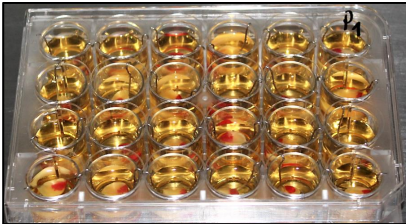
Figura 12. Muestras de esmalte suspendidas en los pocillos con medio de cultivo fresco.
