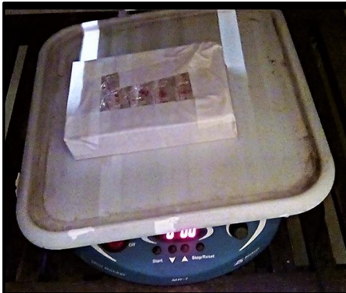
Figura 10. Placa de cultivo con los bloques y la saliva sobre el TapeShake®.
