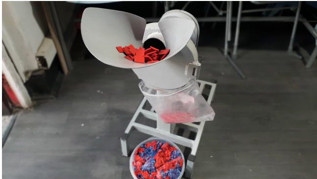
Figura 26: Molinillo eléctrico y proceso de molienda.
