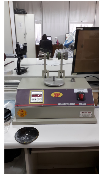
Figura 33: Abrasímetro Taber para prueba de desgaste y abrasión
