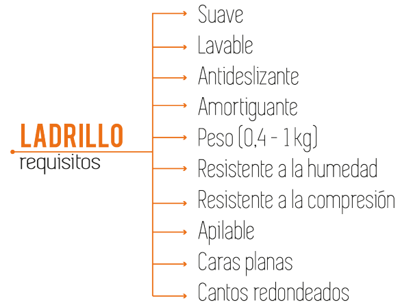
Figura 20: Requisitos ladrillo. Elaboración propia.
