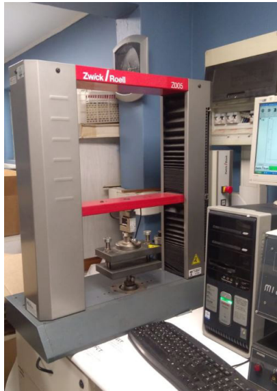
Figura 31: Máquina Zwick Roell Z005 para ensayo de compresión
