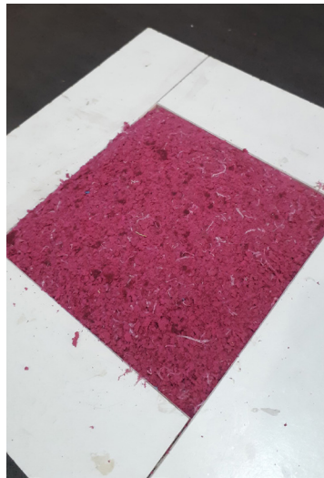
Figura 28: Molde para realizar probetas
