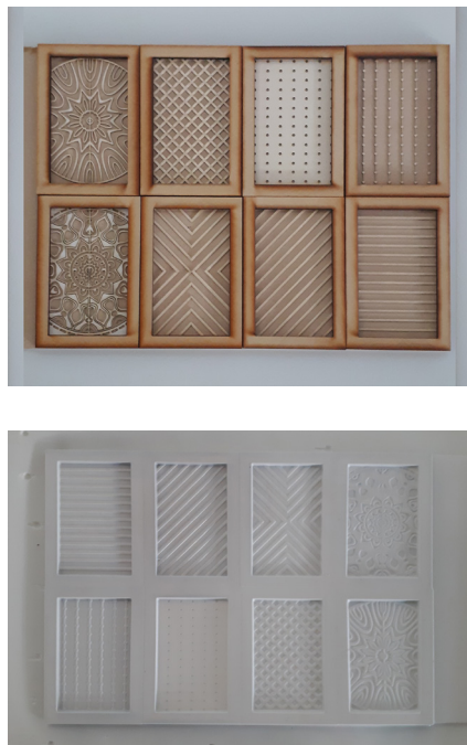
Figura 35: Moldes para probetas de textura superficial
