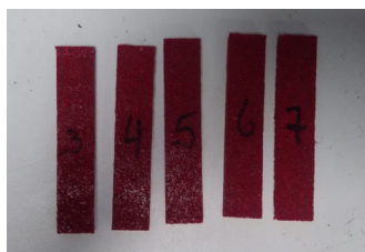
Figura 56: Probetas PVC ensayo compresión
