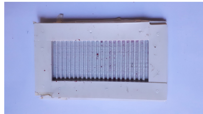
Figura 34: Molde para ensayo de moldeabilidad.
