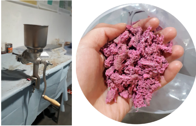
Figura 25:Resultado de molienda mecánica
