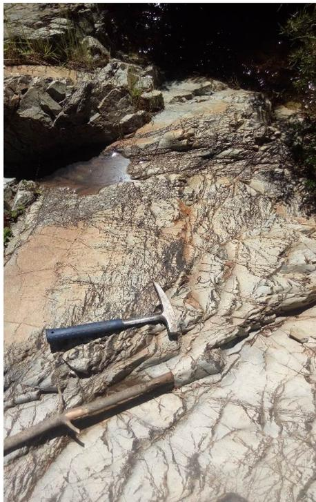
*Figura 35: Andesita con múltiples fracturas*
