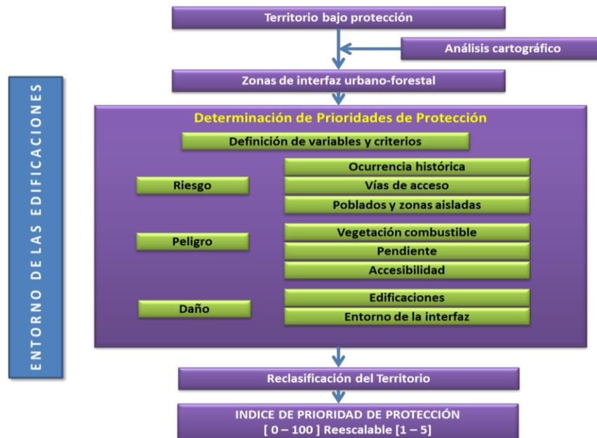
**Figura 12.-** Esquema resumido de la Fase I, correspondiente a la determinación del IPP, en el entorno de las edificaciones con valores brutos entre 0 y 100. La ventaja de este índice es que es reescalable y ajustable a la combinación de otros índices para el logro de un índice de seguridad integrado.
