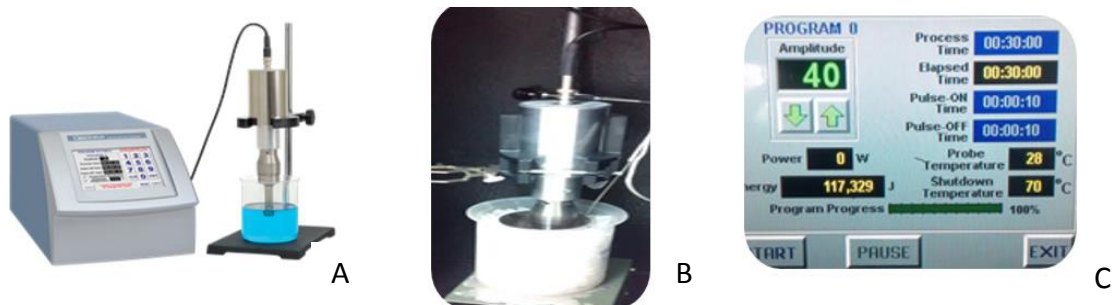
Fig. 6.- Sonicator utilizado en elaboración de nanopartículas de quitina. A) Sonicator Q700. B) Sonda de titanio en muestra, recipiente puesto en un vaso precipitado con agua y sal. C) Panel de control: Amplitud de 40%, Tiempo total de trabajo 30 minutos, pulsación 10 segundos ON y 10 segundos OFF.
